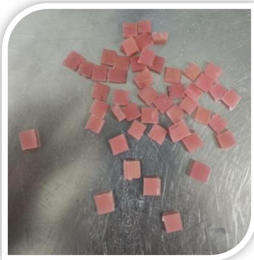
Figura 7. Muestra de acrílico recortadas 10x10mm y 5mm de grosor
