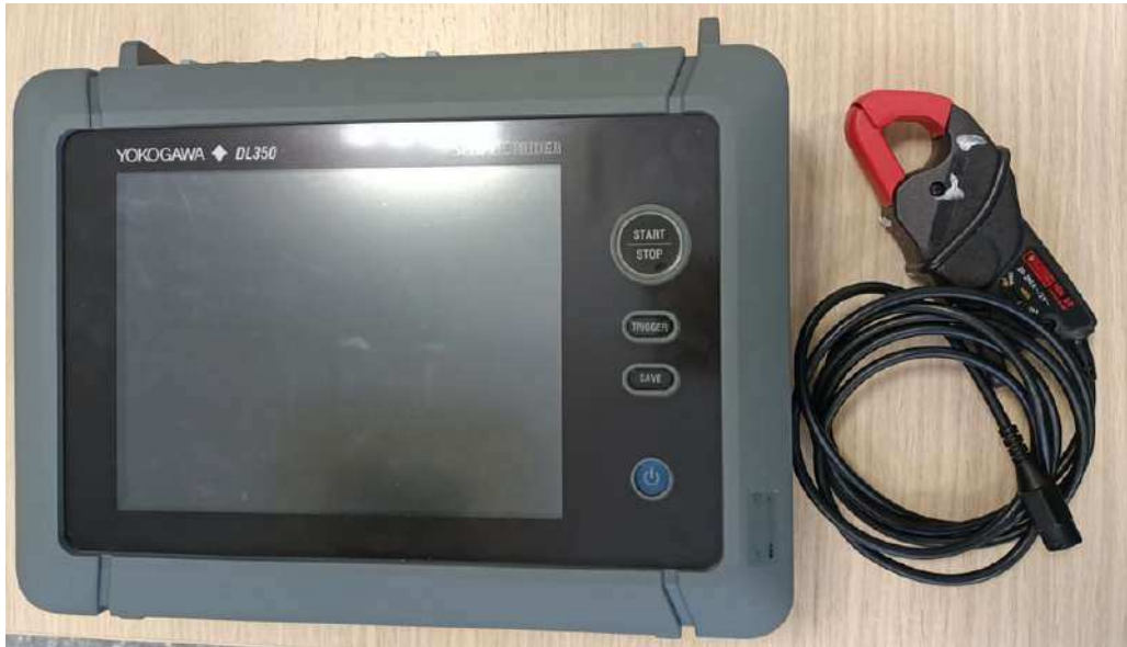
Figura 3.13: Sistema de Adquisición de Datos usado para medir señales de corriente eléctrica en motor de la UPV
