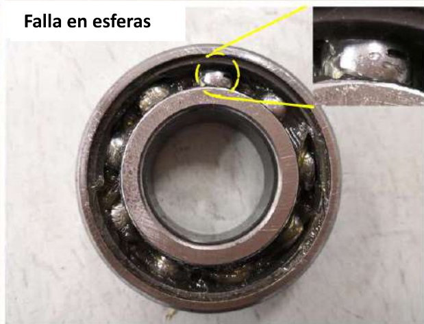
Figura 2.4 Diferentes tipos de falla en rodamientos (traducido de Liu et al. (2020)).
