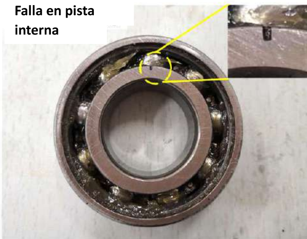
Figura 2.4 Diferentes tipos de falla en rodamientos (traducido de Liu et al. (2020)).
