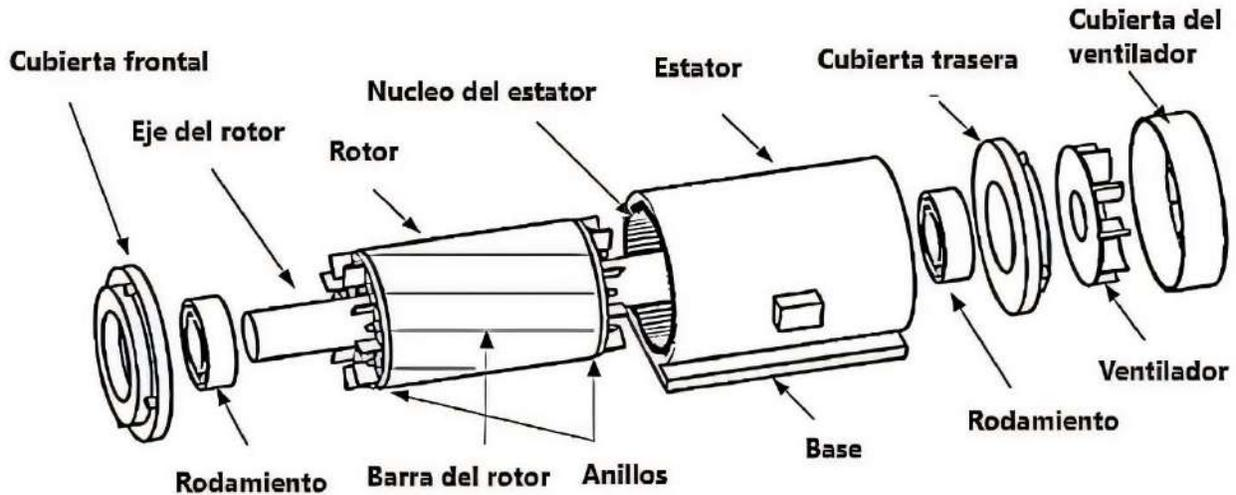
Figura 2.1 Esquema de partes principales que conforman un motor eléctrico de inducción (Traducido de Gangsar & Tiwari, 2020).
