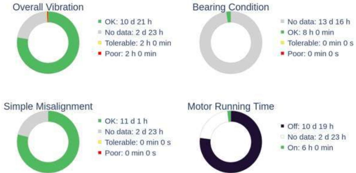
Figura 4.24 ejemplo de un reporte emitido por el sensor Ability Smart Sensor ABB
