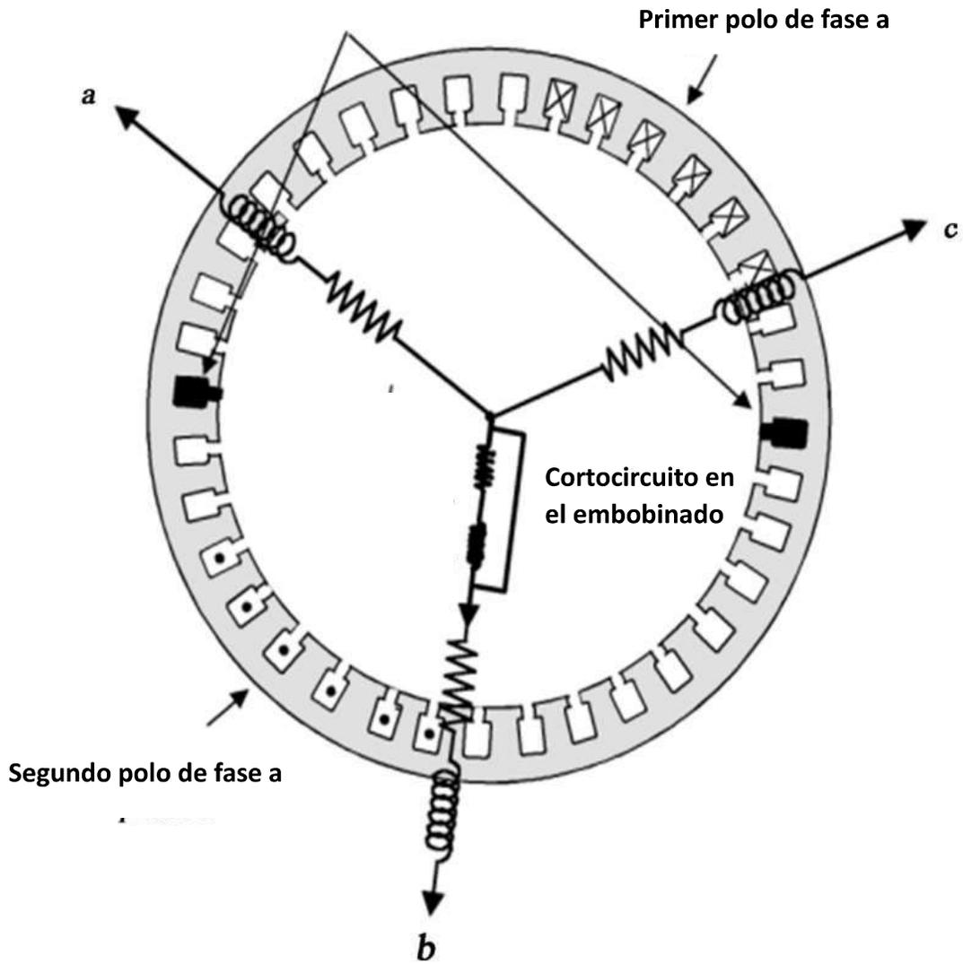
Figura 2.5 Falla en el estator. (traducido de Tegua et al, 2020).
