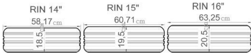
*Ilustración 21. Diferencia de anchos y diámetros correspondientes del rin 14" al rin 16". [37]*
