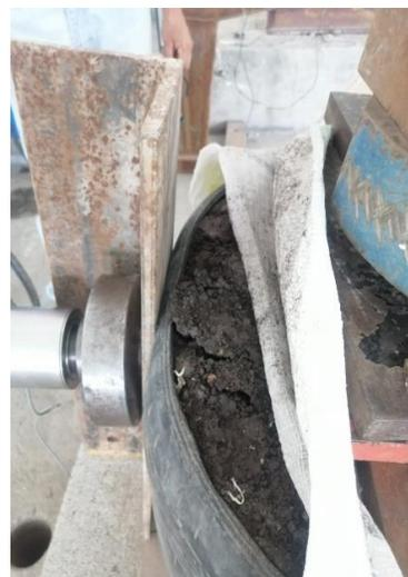
*Ilustración 24. Prueba de carga lateral o tangencial en neumáticos rellenos.*
