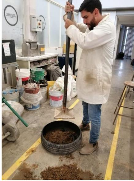
*Ilustración 26. Proceso de corte y relleno de los neumáticos.*
