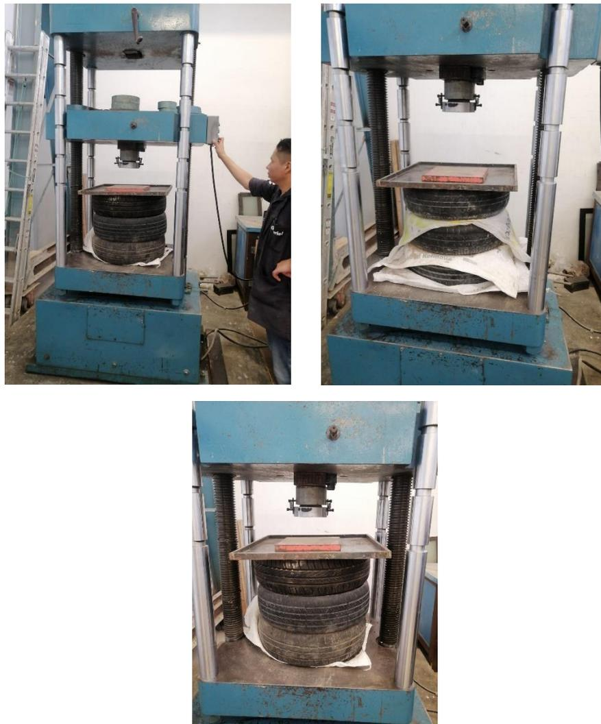
*Ilustración 23. Prueba de carga axial o vertical sobre neumáticos rellenos.*
