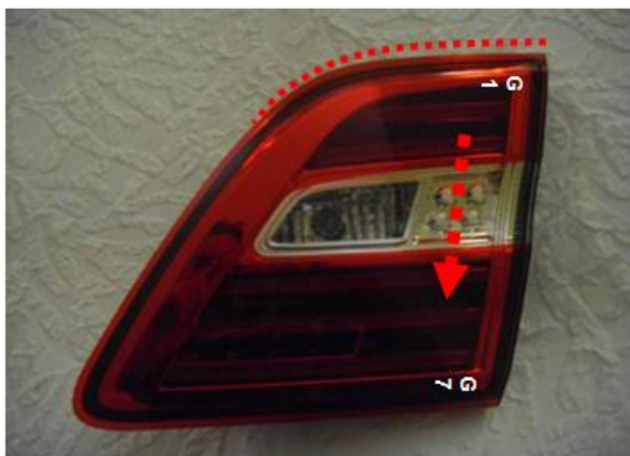
Figura 27. Mediciones de la pieza efectuadas en la CMM, encontrando dos puntos fuera de especificación.
