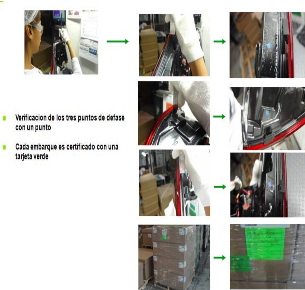
Figura 29. Al medir la característica crítica en la parte se le pone un punto azul para certificar que paso el firewall, además de indicarlo de forma general en el embarque completo.
