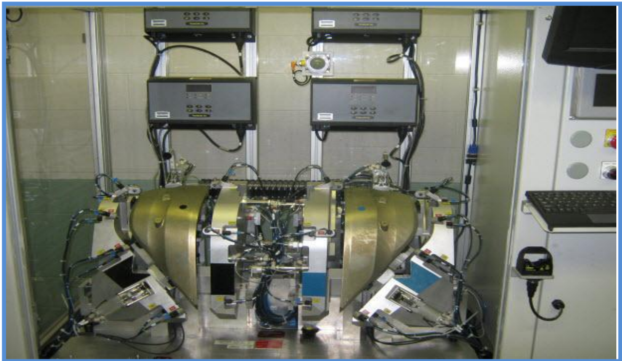
Figura 35. Las piezas son medidas automáticamente por la máquina y sus resultados desplegados en la pantalla.
