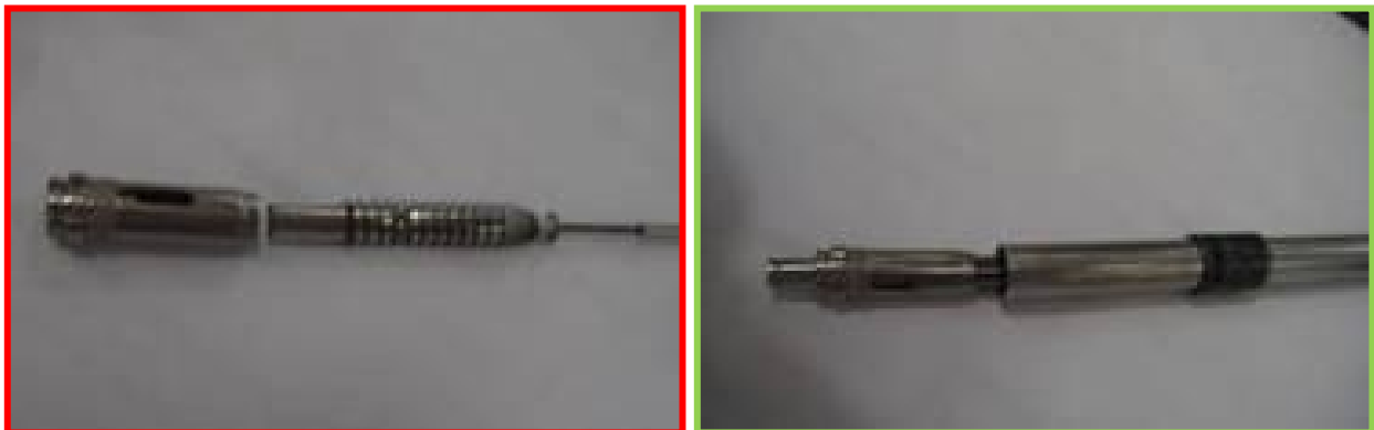
Figura 47. Transductores, izquierda transductor dañado por el uso, derecha transductor nuevo.
