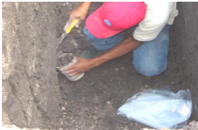
Figura 4.17 Obtención de muestra alterada de las paredes del PCA.
