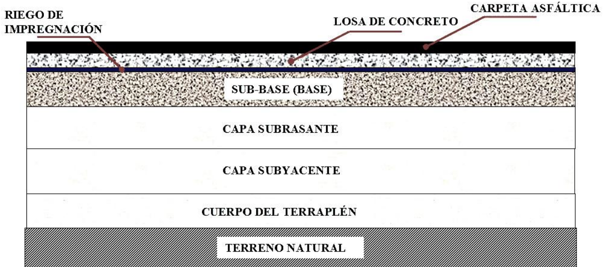
Figura 4.34b Sección estructural típica de un pavimento mixto.
