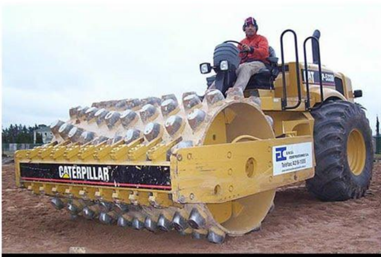
Figura 4.25 Maquinaria para la compactación, Rodillo Pata de Cabra.
