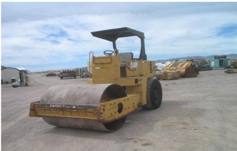
Figura 4.24 Maquinaria para la compactación, Rodillo Vibro-compactador.
