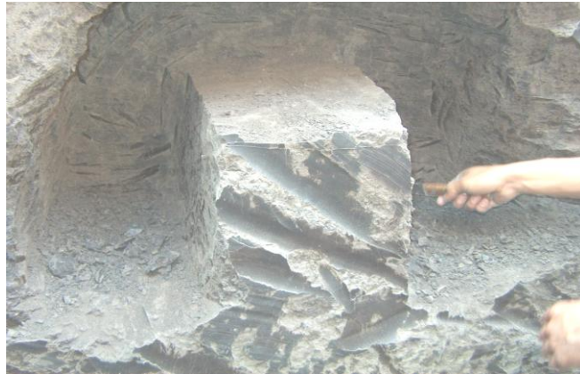
Figura 4.18 Obtención de la muestra inalterada en el fondo el pozo a cielo abierto.
