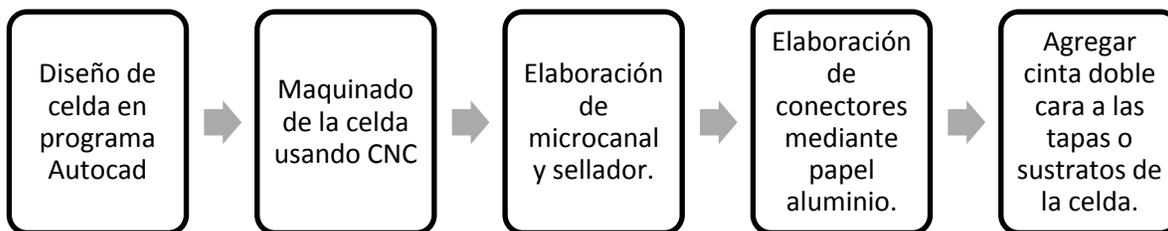
Figura 9.-Representación esquemática de la elaboración de las partes del dispositivo
