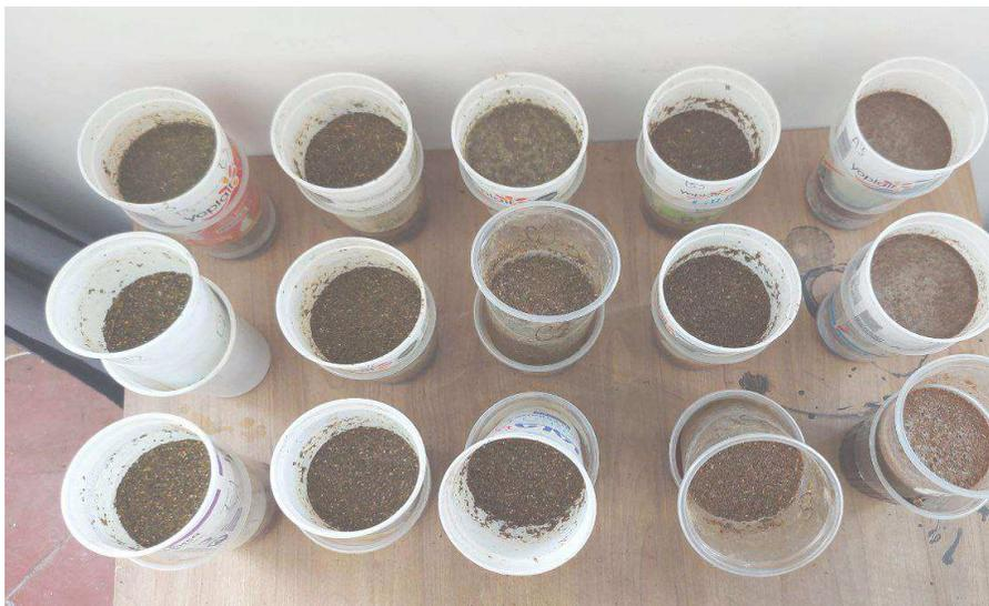
*Figura 2 Determinación de capacidad de retención de agua.*
