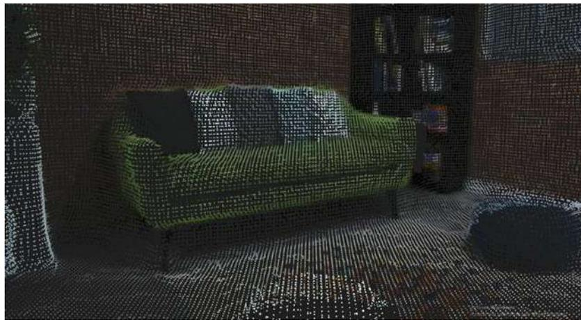
**Figura 3.** Reconstrucción de un espacio usando nubes de puntos [25].
