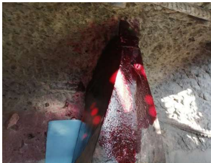
Figura 2. 7 Aplicación de técnicas de líquido penetrante en la botella del tirante 5 semi-arpa 1 del Puente Rio Papaloapan.
