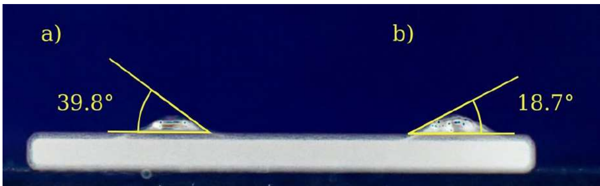
Figura 4.1: Ángulo de contacto para dos gotas, a) de solución A, precursora de de la perovskita \text{SrTiO}_3 y b) de solución B, precursora de de la perovskita \text{SrTiO}_3 con surfactante Pluronic F-127. Ángulos calculados con la ayuda del programa ImageJ[99].
