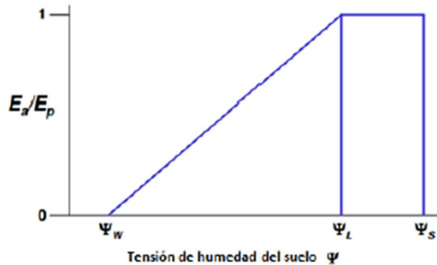
Figura 5. Dependencia de la relación entre evaporación real y potencial en la tensión de humedad de suelo (Feddes et al, 1976).
