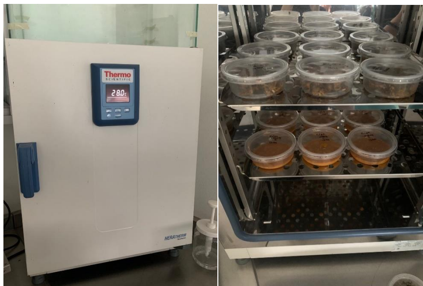
Figura 9. Colocación de contenedores experimentales en incubadora a 28°C
