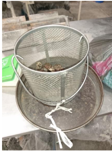
Figura 4.11 Gravas en canastilla para obtener peso en agua (banco Tlacote)
