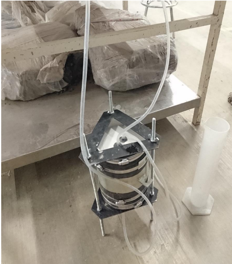
Figura 3.8 Permeámetro totalmente conectado a mangueras de carga y descarga.
