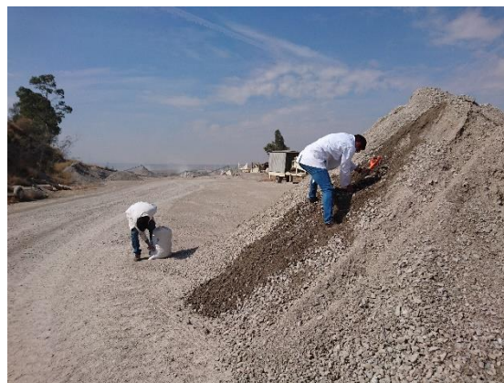
Figura 3.5 Muestreo en canal del material para base (banco Los Ángeles).
