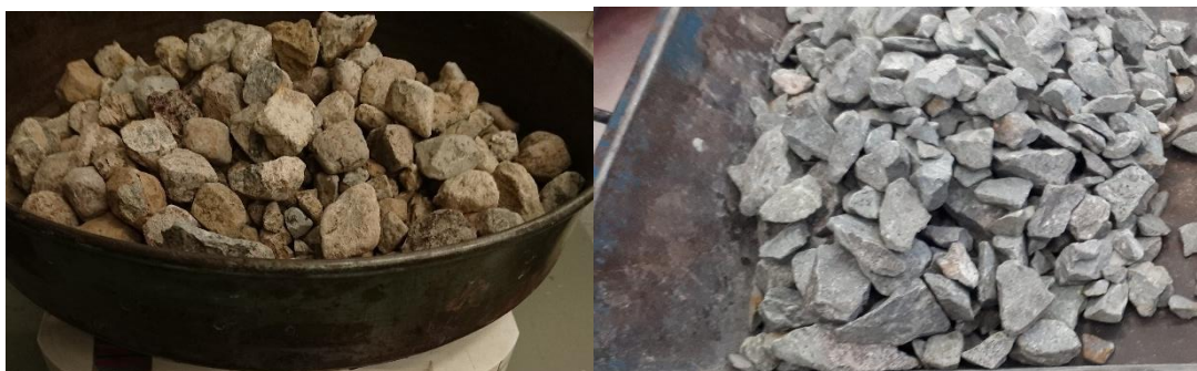
Figura 4.28 a) material para base hidráulica (banco el Tlacote); b) material para base hidráulica (banco los Ángeles).
