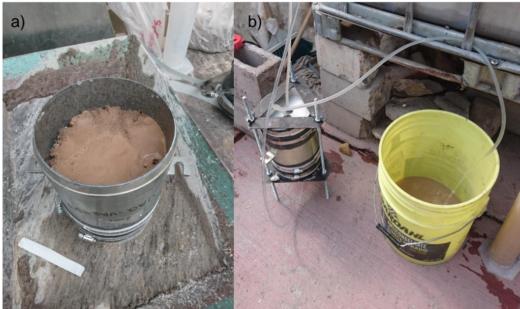
Figura 4.26 a) material al finalizar la prueba; b) recipiente con agua y material fino producto del transporte en el agua.
