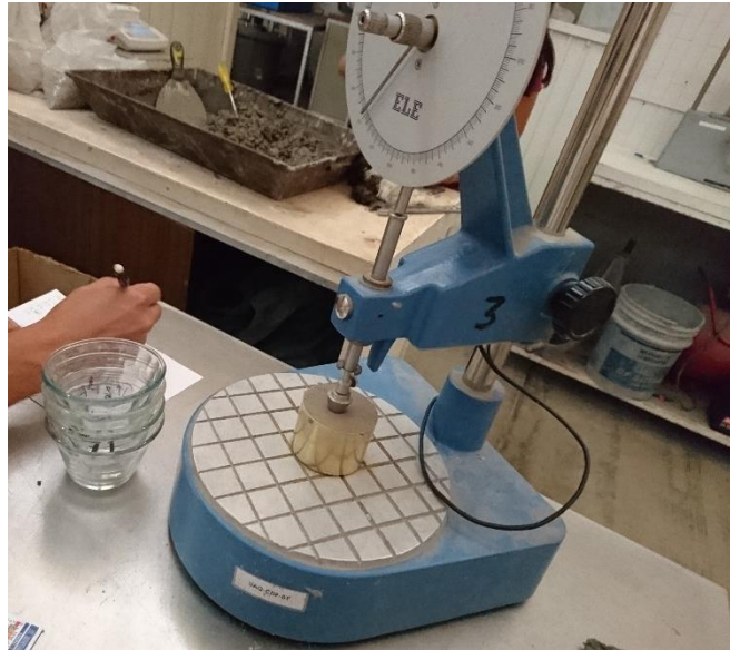
Figura 4.7 Cono inglés de penetración para la obtención del límite líquido.
