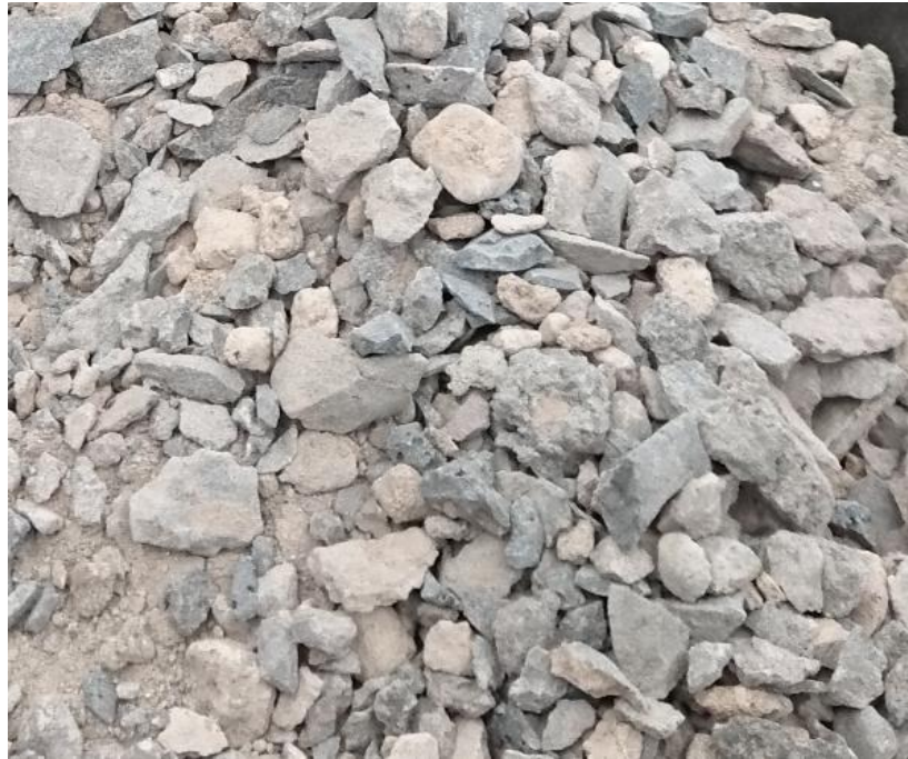
Figura 4.27 Material para base hidráulica del banco el Nabo.
