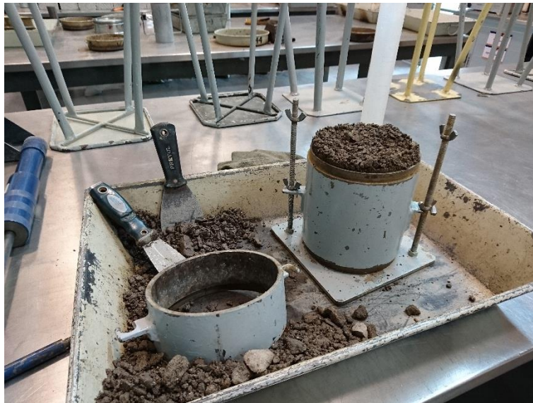
Figura 4.9 Punto de compactación en el material ensayado.
