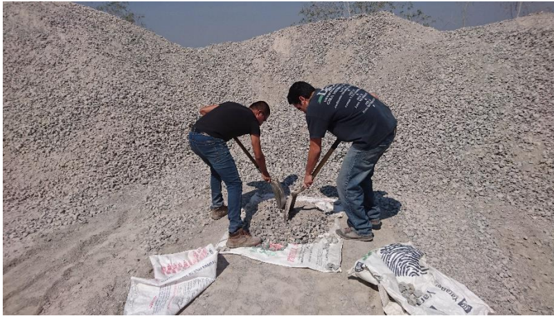
Figura 3.6 Reducción de la muestra por cuarteo (banco Los Ángeles).
