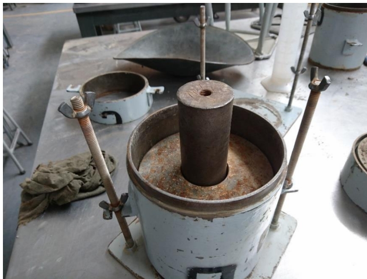
Figura 4.23 Muestra compactada previa al CBR con pistón de penetración colocado.
