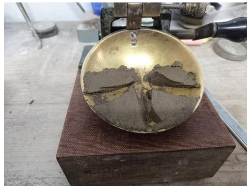
Figura 4.5 (izquierda) secado del material para límite líquido y plástico, Figura 4.6 (derecha) copa de Casagrande con el material cerrado a \frac{1}{2} “.
