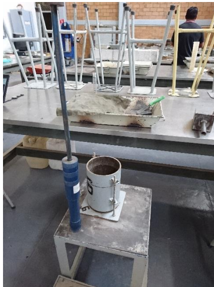
Figura 4.8 Pisón de compactación y molde de compactación para ensaye Proctor modificado.
