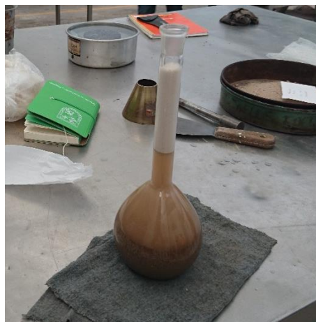
Figura 4.12 Matraz con arena para prueba de gravedad específica (banco Tlacote)
