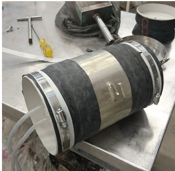
Figura 3.7 Prototipo de permeámetro ensamblado sin placas de presión.
