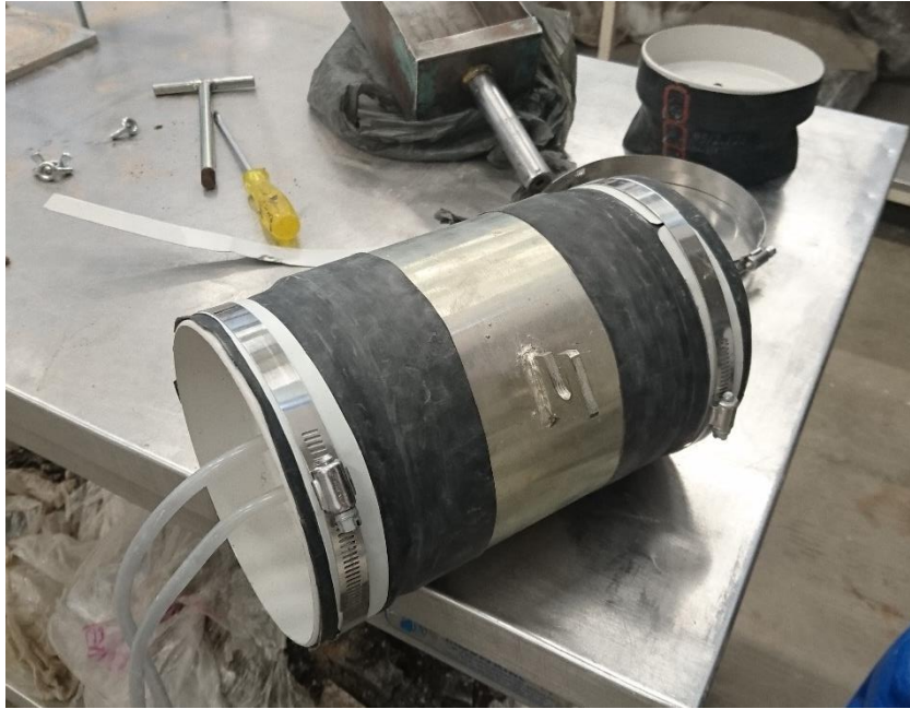
Figura 4.25 Molde de compactación usado como permeámetro de carga constante.
