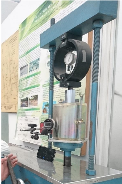
Figura 4.24 Muestra ensayada en la prensa de compresión para el CBR, a una velocidad constante de 1.27 mm por minuto.
