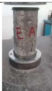
A3. Ensayo a compresión a los veintiún días en concreto de concreto base.
