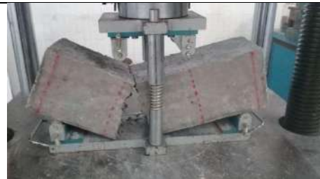
D6. Ensayo a flexión a los veintiocho días en concreto con 15% de SBR y sin aditivos.
