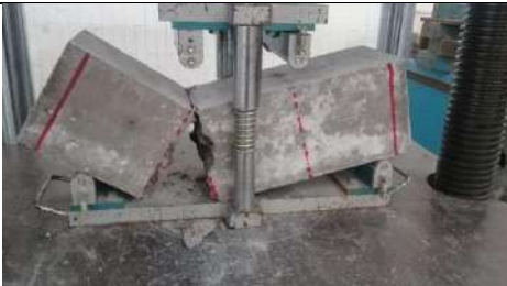
G5. Ensayo a flexión a los veintiocho días en concreto con 25% de SBR con aditivos.
