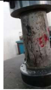
G2. Ensayo a compresión a los catorce días en concreto con 25% de SBR con aditivos.
