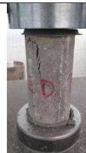
D4. Ensayo a compresión a los veintiocho días en concreto con 15% de SBR y sin aditivos.
