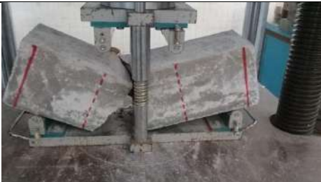
B5. Ensayo a flexión a los veintiocho días en concreto con 5% de SBR y sin aditivos.
