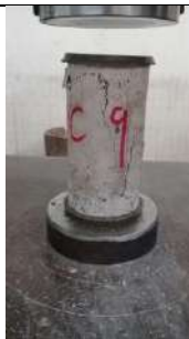
C3. Ensayo a compresión a los veintiún días en concreto con 25% de SBR y sin aditivos.
