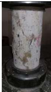
E3. Ensayo a compresión a los veintiún días en concreto con 5% de SBR y con aditivos.
