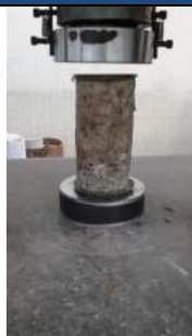
A1. Ensayo a compresión a los siete días en concreto de concreto base.
