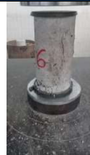
C2. Ensayo a compresión a los catorce días en concreto con 25% de SBR y sin aditivos.
