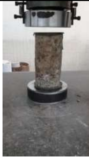
G1. Ensayo a compresión a los siete días en concreto con 25% de SBR con aditivos.
