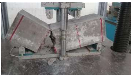
A5. Ensayo a flexión a los veintiocho días en concreto de concreto base.
