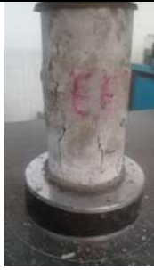
E1. Ensayo a compresión a los siete días en concreto con 5% de SBR y con aditivos.
