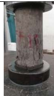
F4. Ensayo a compresión a los veintiocho días en concreto base con aditivos.
