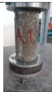
A4. Ensayo a compresión a los veintiocho días en concreto de concreto base.
