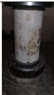
D3. Ensayo a compresión a los veintiún días en concreto con 15% de SBR y sin aditivos.
