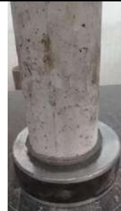
E2. Ensayo a compresión a los catorce días en concreto con 5% de SBR y con aditivos.
