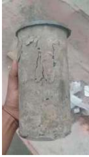
B1. Ensayo a compresión a los siete días en concreto con 5% de SBR y sin aditivos.
