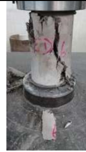
D2. Ensayo a compresión a los catorce días en concreto con 15% de SBR y sin aditivos.
