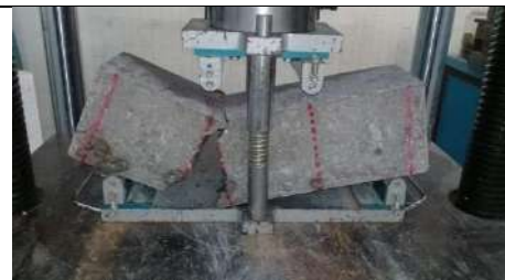
C6. Ensayo a flexión a los veintiocho días en concreto con 25% de SBR y sin aditivos.
