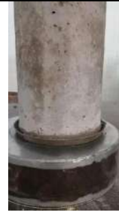
F2. Ensayo a compresión a los catorce días en concreto base con aditivos.
