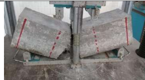
B6. Ensayo a flexión a los veintiocho días en concreto con 5% de SBR y sin aditivos.
