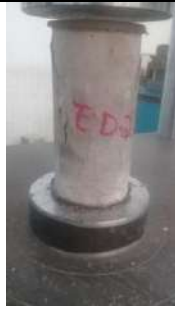
D1. Ensayo a compresión a los siete días en concreto con 15% de SBR y sin aditivos.
