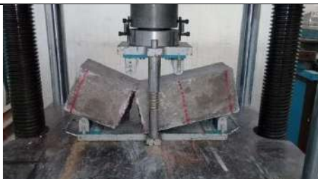
C5. Ensayo a flexión a los veintiocho días en concreto con 25% de SBR y sin aditivos
