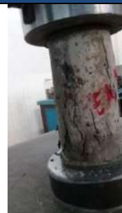
A2. Ensayo a compresión a los catorce días en concreto de concreto base.
