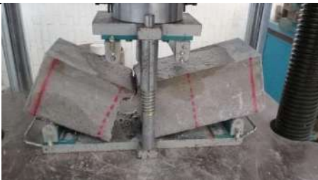
F5. Ensayo a flexión a los veintiocho días en concreto base con aditivos.
