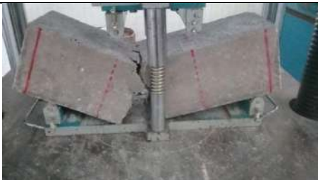
D5. Ensayo a flexión a los veintiocho días en concreto con 15% de SBR y sin aditivos.
