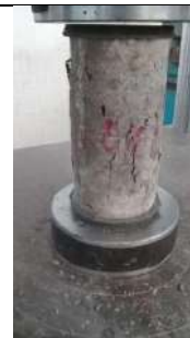
E4. Ensayo a compresión a los veintiocho días en concreto con 5% de SBR y con aditivos.
