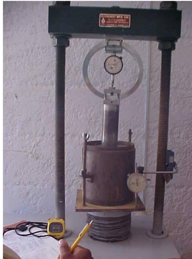
Figura III.16. Prueba para obtener el Valor de Soporte California (CBR)
