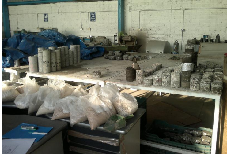
Figura III.9. Preparación de pastillas de mezcla asfáltica previo al ensayo
