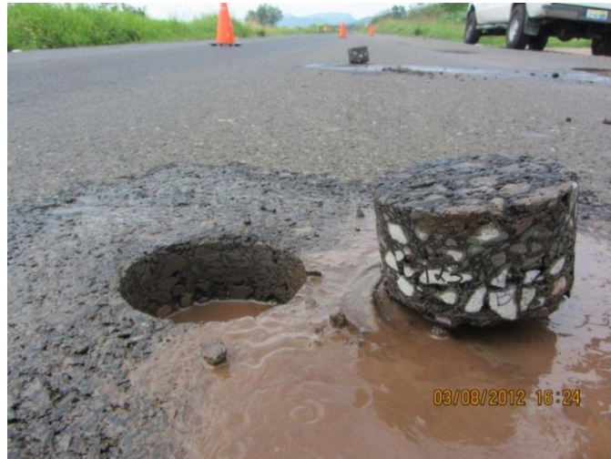
Figura III.6. Núcleo de carpeta asfáltica con un espesor de 5.5 cm
