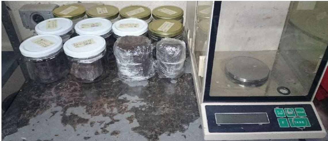
Figura 3.8 Muestras de suelo en frascos herméticos para succión total y muestras selladas para succión mátrica.
