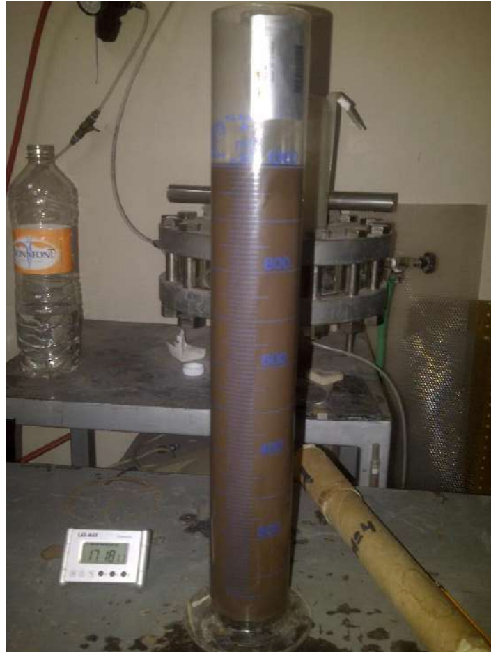
Figura 3.4 Realización de prueba de granulometría mediante el hidrómetro
