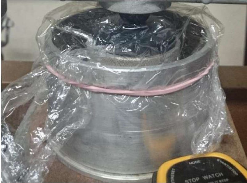
Figura 3.10 Muestra de suelo montada y cubierta para evitar contacto con el ambiente
