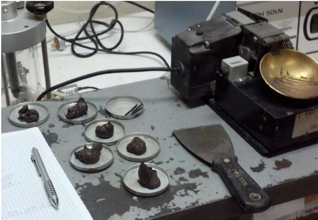
Figura 3.5 Realización de prueba de límite líquido mediante la copa de Casagrande y limite plástico.
