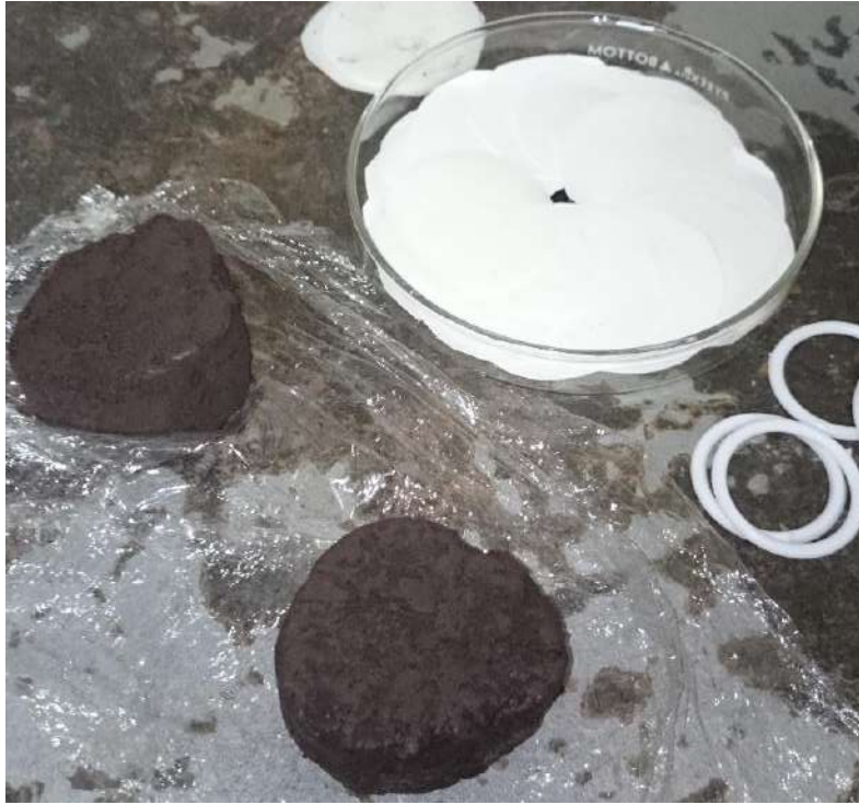
Figura 3.7 Muestra de suelo y papel filtro para obtener succión mátrica (papel en contacto).
