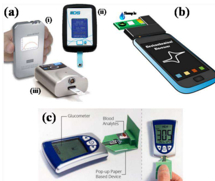
Figura 6. Ejemplos representativos de biosensores portátiles. A) Potenciostatos de bolsillo. B) Potenciostatos basados en teléfonos inteligentes. C) Glucómetro convencional (da Silva et al., 2017).
