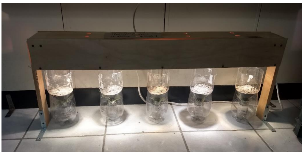
Figura 7. Embudos tipo Berlese-Tullgren bajo lámparas de luz, fabricado por Vergara-Pineda Santiago. Fotografía de L. Daniela Bonilla Hernández, 2019.
