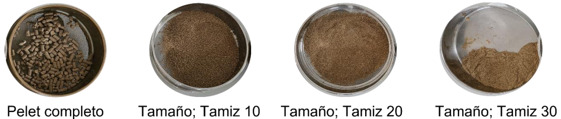
Figura 6. Alimento elaborado y separado por diferentes tamaños; tamiz 30 (0.5 mm), tamiz 20 (0.8 mm) y tamiz 10 (2 mm).
