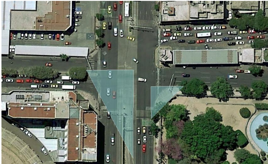
Fig. 4.1 Triángulos de visibilidad por tipo de giro, (ejemplificación gráfica).
