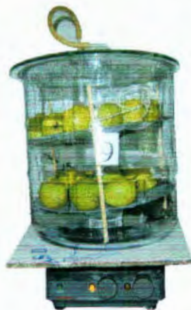
Figura 9. Disposición de frutos en cámara hermética expuestos a 1-MCP.
