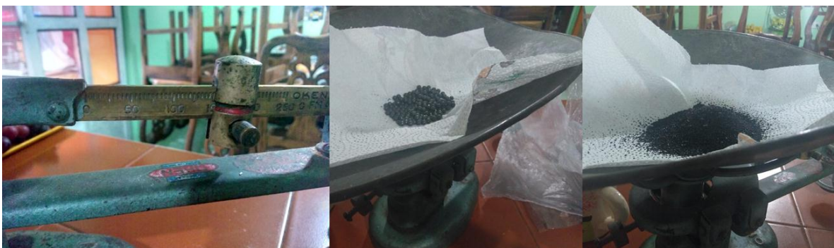
Figura 36. Comparación de 150 g. de balines y 150 g. de arena metálica. A simple vista, la arena, que a pesar de estar conformada por granos milimétricos, el volumen que representa es garrafal a diferencia del que proporciona el conjunto de balines. Elaboración propia.
