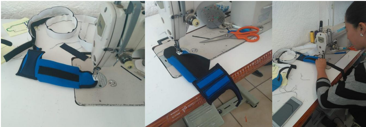
Figura 64. De izquierda a derecha; a) Confección de bias elástico. b) Manufactura de compartimento para balines. c) Lilian Moysén confeccionando producto final. Elaboración propia.
