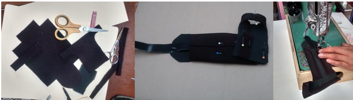
Figura 43. De izquierda a derecha, a) Piezas de textil de neopreno. b) Estructuración antes de confección c) confección de prototipo. Elaboración propia.
