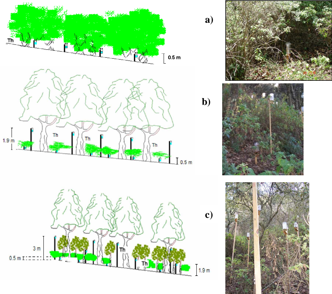
Figura 14. Dispositivos de medición del flujo de traslocación en la parcela experimental de la microcuenca La Barreta. (a) Ecosistema con un estrato de vegetación, (b) Ecosistema con 2 estratos de vegetación, (c) Ecosistema con 3 estratos de vegetación (esquema sin escala), Th es el flujo de traslocación.
