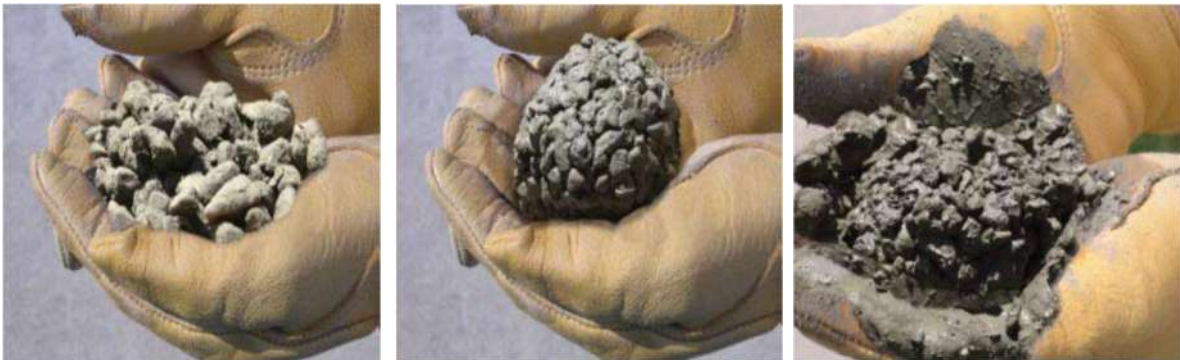
Figura 2.7 Muestras de concreto permeable con diferentes relaciones agua-cemento (A/C).
