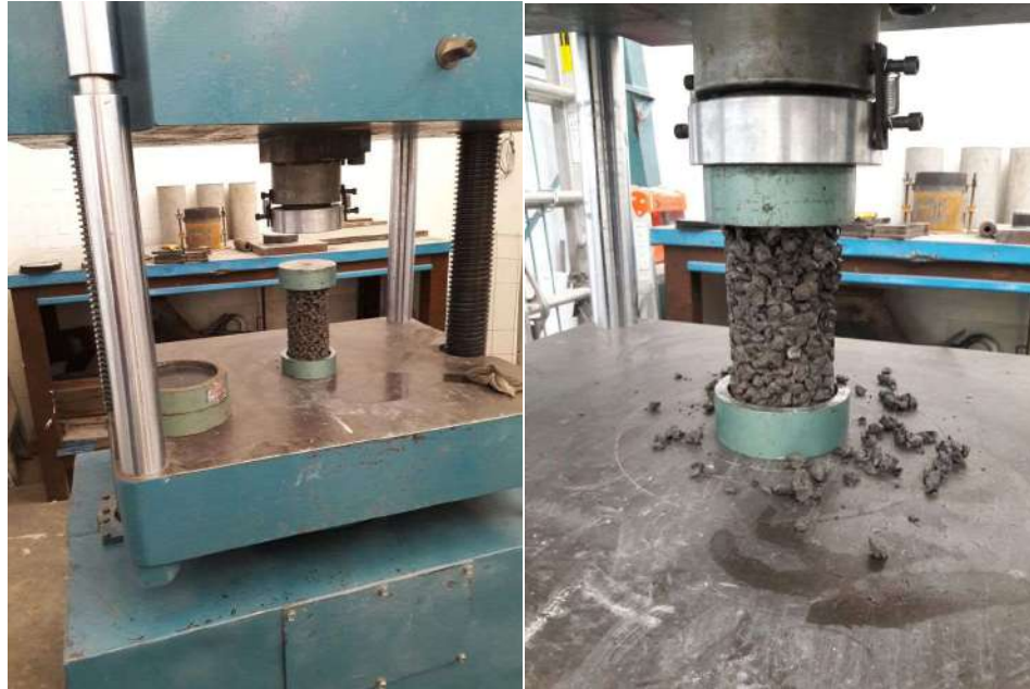
Figura 4.11 Ensayo de resistencia a compresión.
