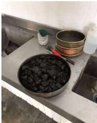
Figura 3.12 Determinación de la condición saturada superficialmente seca de una grava.
