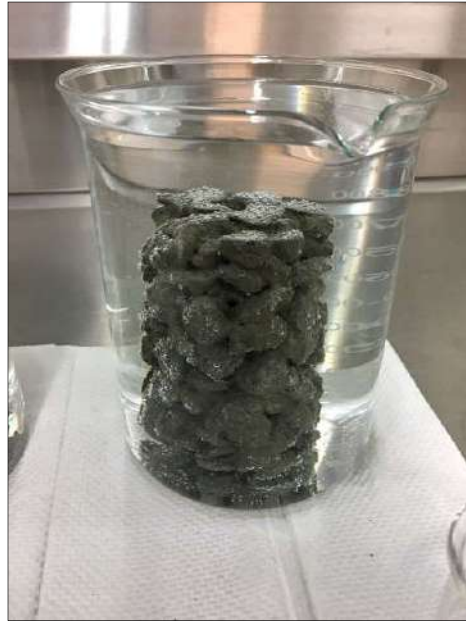
Figura 3.18 Especímenes de concreto permeable para lotes de absorción de metales pesados.
