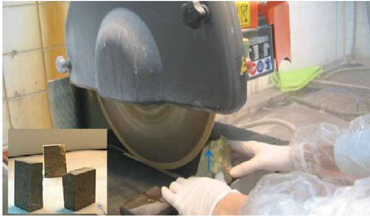
Figura 3.7 Corte de la roca.
