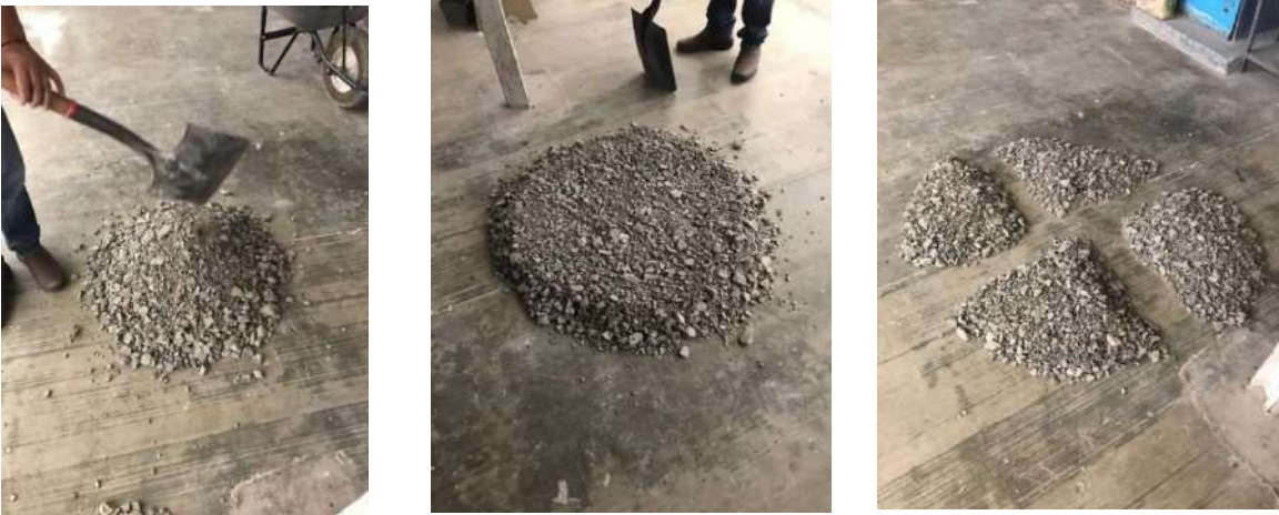
Figura 4.4 Reducción del agregado grueso por medio del cuarteo manual.
