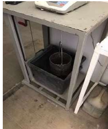
Figura 3.12 Determinación de la condición saturada superficialmente seca de una grava.
