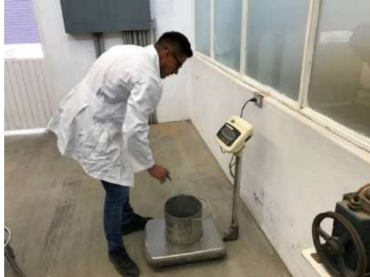
Figura 3.13 Medición del volumen y peso del recipiente para determinar las masas volumétricas.
