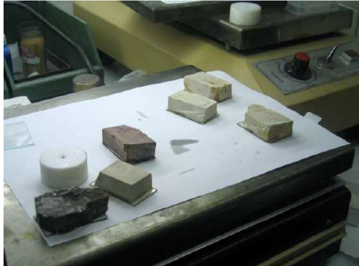
Figura 3.9 Utilización de una plancha caliente para secar la muestra.
