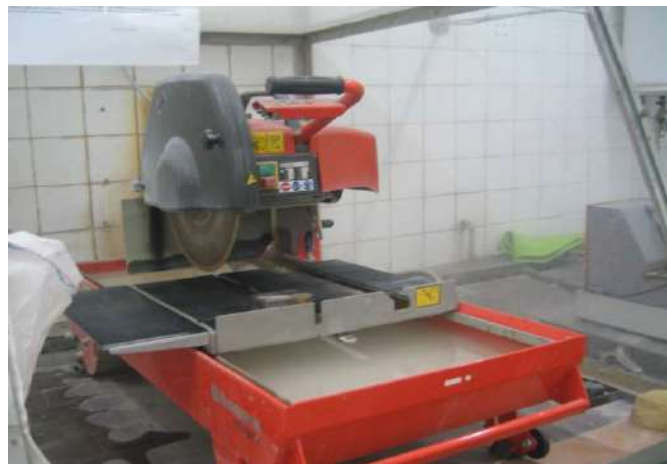
Figura 3.6 Utilización de la cortadora para poner una cara plana de la roca.
