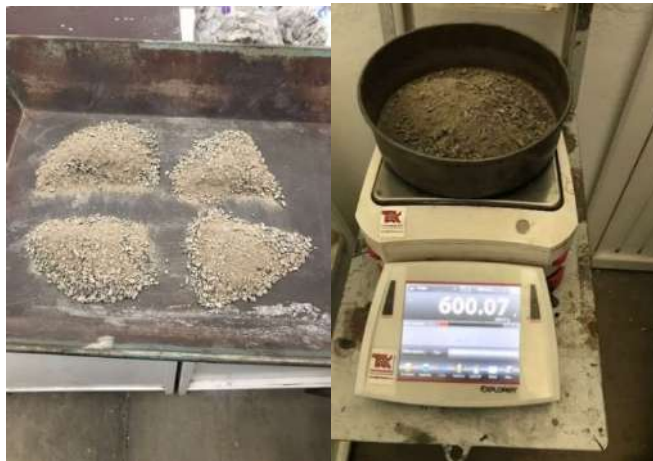
Figura 4.5 Reducción del agregado fino por medio del cuarteo manual. Fuente: Elaboración propia.
