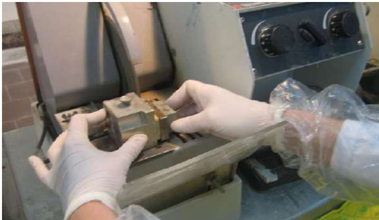
Figura 3.10 Cortadora-rectificadora de muestras a 30 micras.
