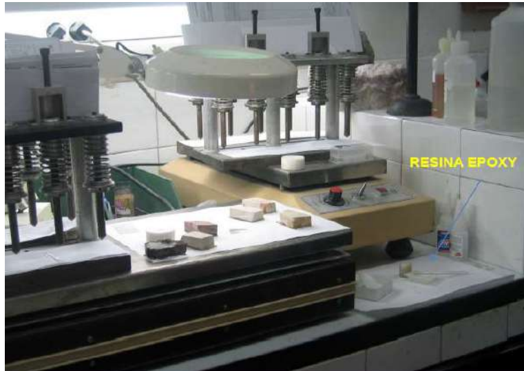
Figura 3.8 Utilización de resina epoxi para pegar el porta objetos.
