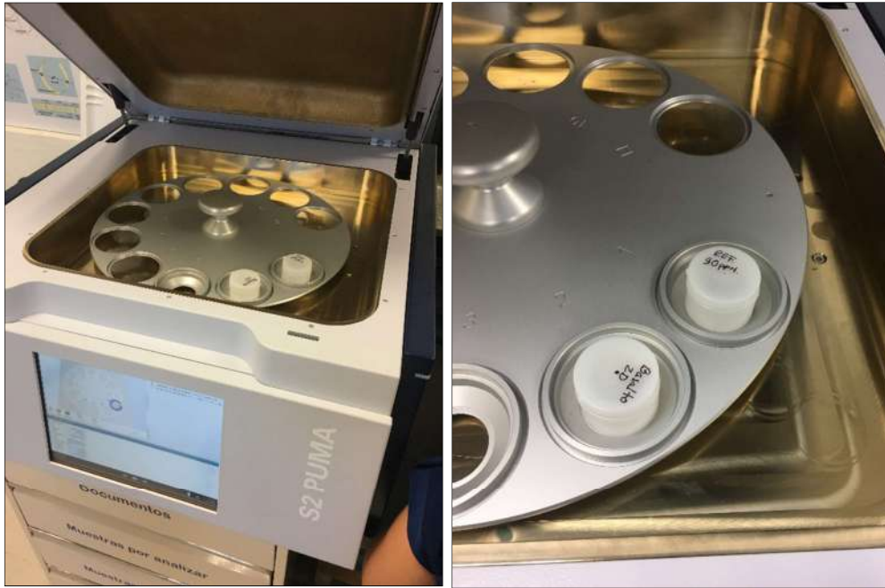
Figura 3.26 Colocación de los especímenes en el equipo S2 PUMA
