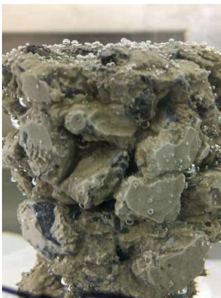
Figura 4.21 Cilindro de concreto permeable expuesto a solución con arsénico. Fuente: Elaboración Propia.
