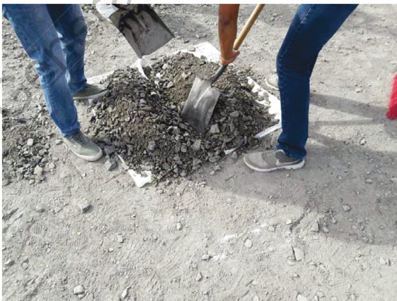
Figura 3.5. Reducción de muestras de los agregados.
