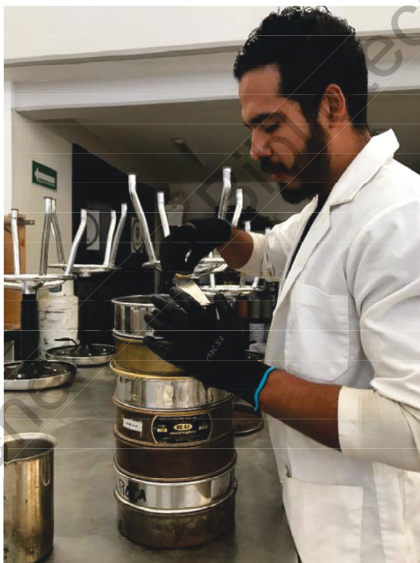
Figura 3.6. Juego de mallas utilizadas en el ensaya granulométrico.
