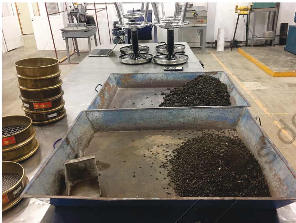
Figura 4.5. Ensaye granulométrico al asfalto reciclado.
