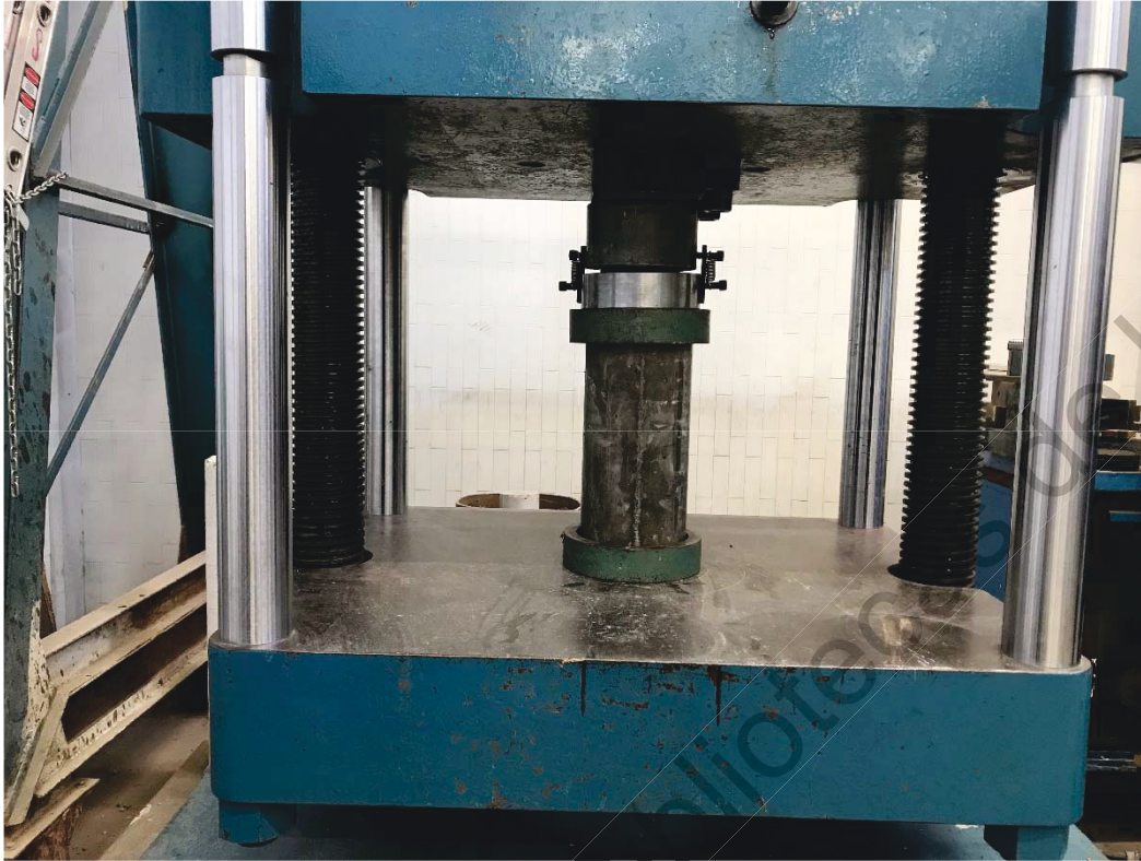
Figura 3.10. Prensa utilizada para ensayo a compresión simple.
