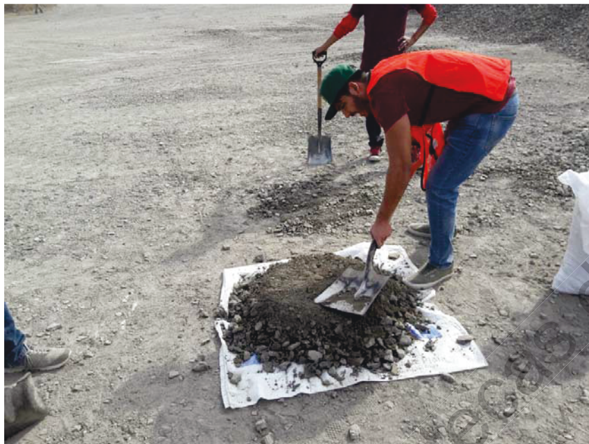
Figura 3.4. Muestreo del material de banco.
