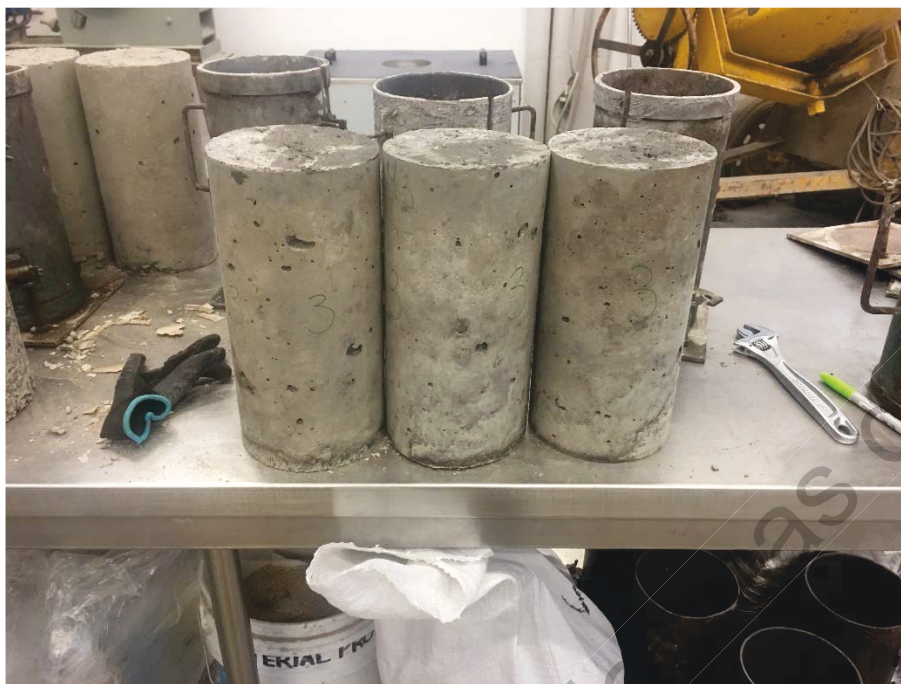
Figura 3.8. Cilindros de concreto antes de iniciar curado.
