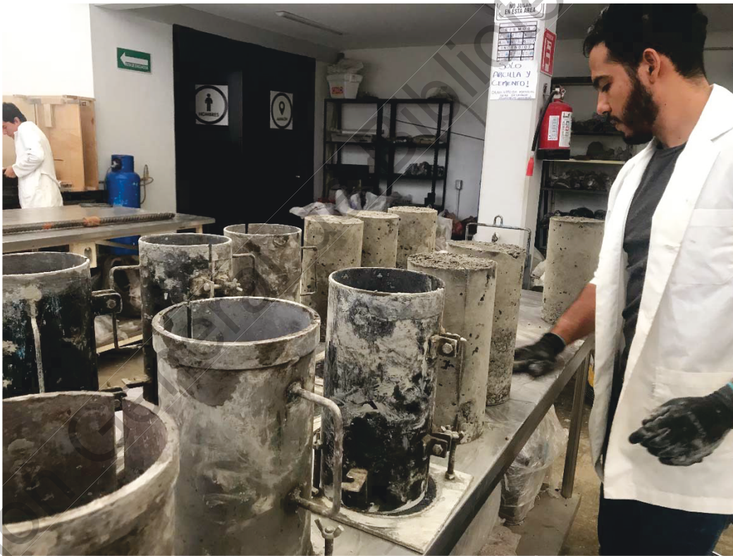
Figura 4.7. Elaboración de cilindros de concreto.
