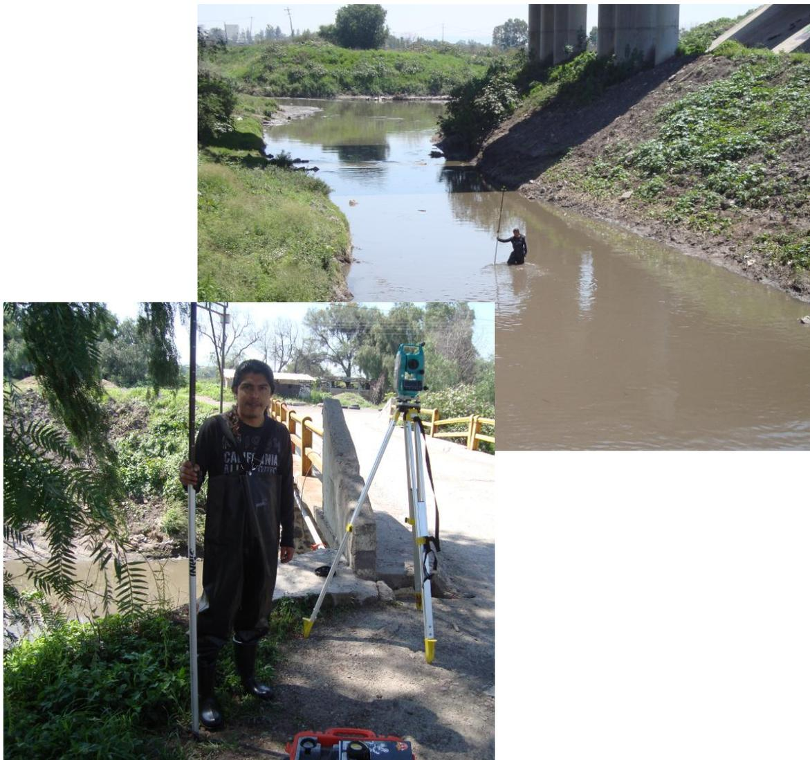
**Figura 3.8** Levantamiento de secciones en el punto de salida de la cuenca conocido como las Adjuntas.
