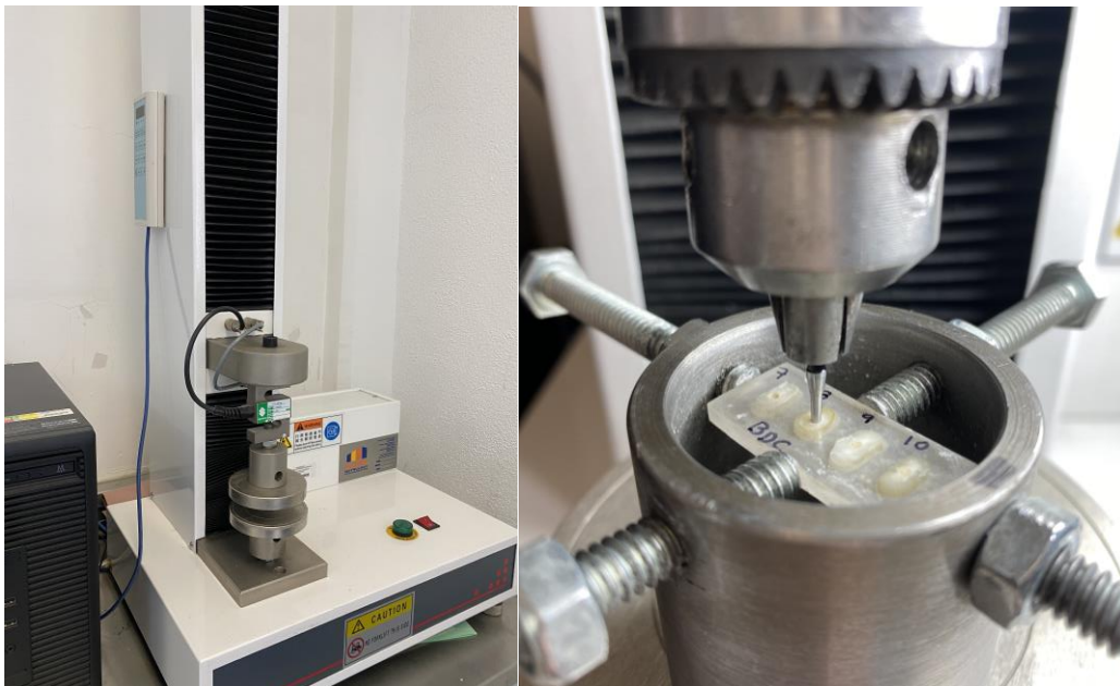
Figura 11. (A) Máquina Universal de Ensayos. (B) Probeta ejerciendo una presión hacia abajo sobre la superficie del cemento reparador a una velocidad constante de 1mm/min.
