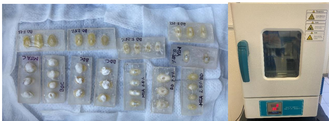
Figura 10. (A) Muestras en recipiente de plástico sobre gases humedecidas en agua destilada. (B) Muestras almacenadas a 37°C y 100% de humedad durante 48 horas.
