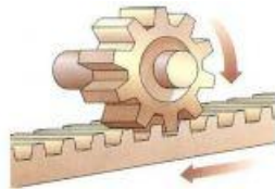
Figura 3.10.2 Mecanismo piñón cremallera
