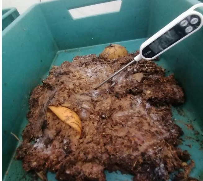
Figura 9. Toma de temperaturas dentro de los larveros
