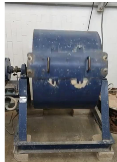
Figura 3 Máquina para prueba de desgaste de los ángeles en laboratorio UAQ
