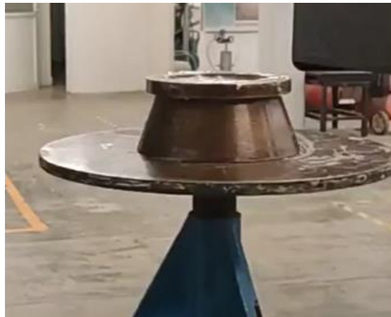
Figura 33 Prueba de fluidez para los especímenes de Resina con calcita
