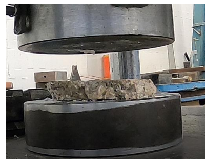
Figura 41. Falla del Espécimen I RC5050.
