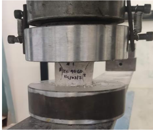
Figura 47 Falla del espécimen RCC4060
