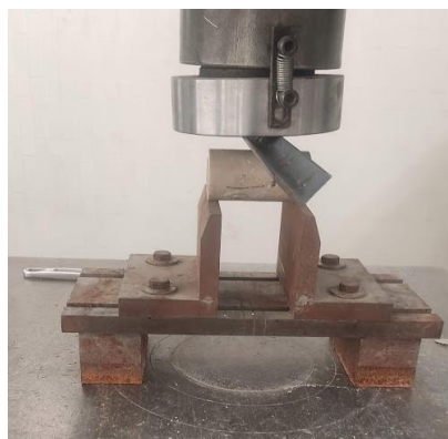
Figura 63 Ensayo de tensión indirecta para RCC3070.
