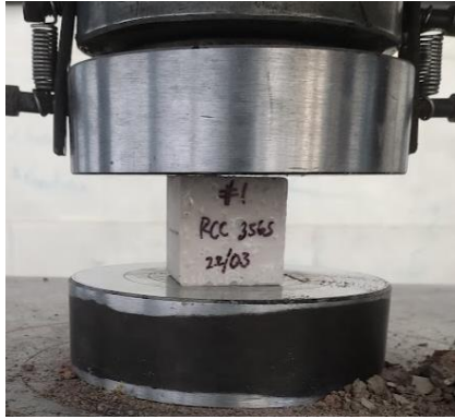
Figura 48 Espécimen RCC3565 para prueba.
