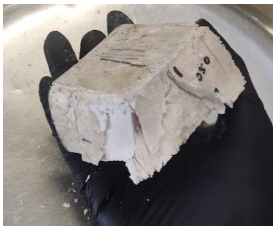
Figura 44. Falla del espécimen RCC5050.
