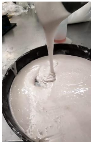
Figura 11. Consistencia de mezcla Resina calcita RC5050
