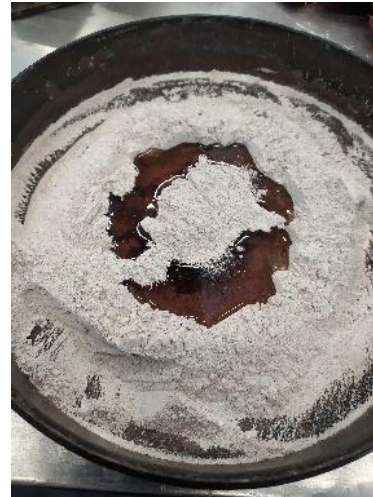
Figura 30. Materiales para el espécimen Resina-Calcita-Arena RCCA303040
