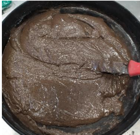
Figura 31. Consistencia mezcla Resina-Calcita-Arena RCCA303040
