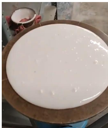
Figura 34 Prueba de fluidez en proceso.
