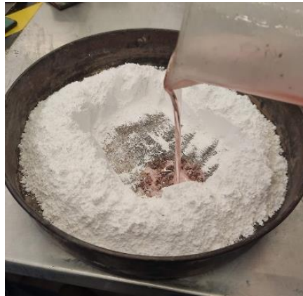
Figura 10. Procedimiento resina calcita RC5050
