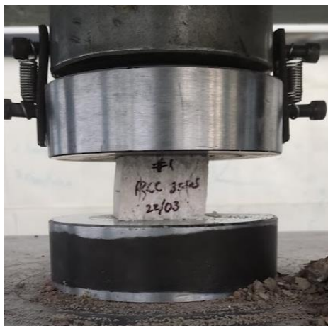
Figura 50 Falla del espécimen RCC3565
