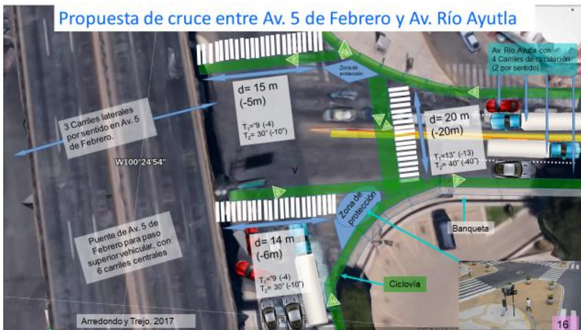
Figura 5.14. Solución propuesta para el cruce entre Av. 5 de Febrero y Av. Río Ayutla.
