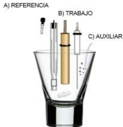
Figura 10. Celda electroquímica con tres electrodos, a) electrodo de referencia, b) electrodo de trabajo y c) electrodo auxiliar (Kissinger & Heineman, 1996).
