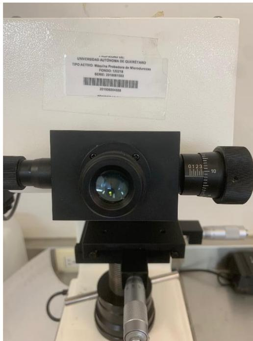
**Figura 23.** Durómetro CMS Metrology.
