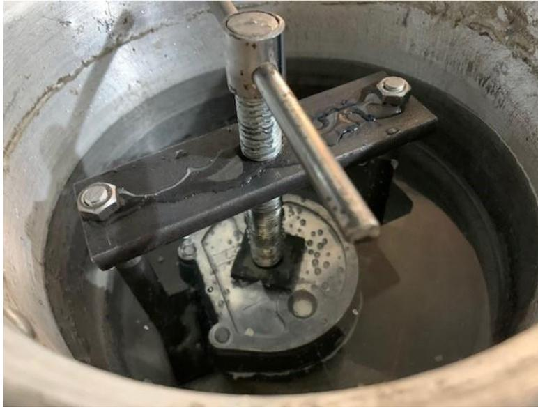
**Figura 9.** Mufla dentro de olla metálica para procesamiento
