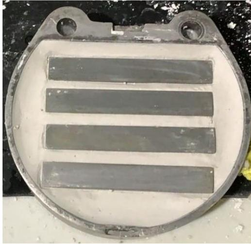
**Figura 4.** Placas metálicas sumergidas en yeso blancanieves
