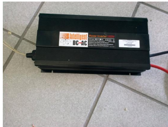
Figura. 3.1.1.4 inversor de voltaje DC-AC, intelligent 12VCD-120VCA / 1500W.
