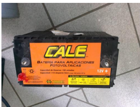
Figura. 3.1.1.2 batería de aplicaciones fotovoltaicas para 12VCD marca CALE
