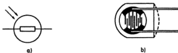
Figura 2.4 Fotorresistencia (LDR). a) Símbolo. b) Modelo de bajo costo encapsulado en plástico transparente. Pallas (2003).
