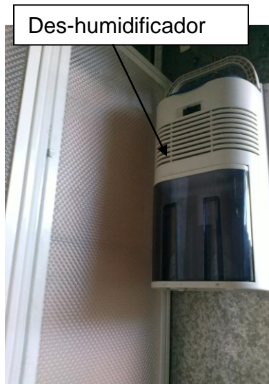
Figura 3.2.4.1 Des-humidificador en el interior del fitotrón.
