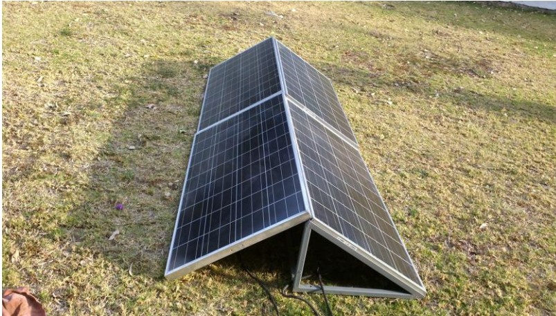
Figura 4.1.8 paneles solares encargados de abastecer de energía eléctrica los componentes de control para el fitotrón.
