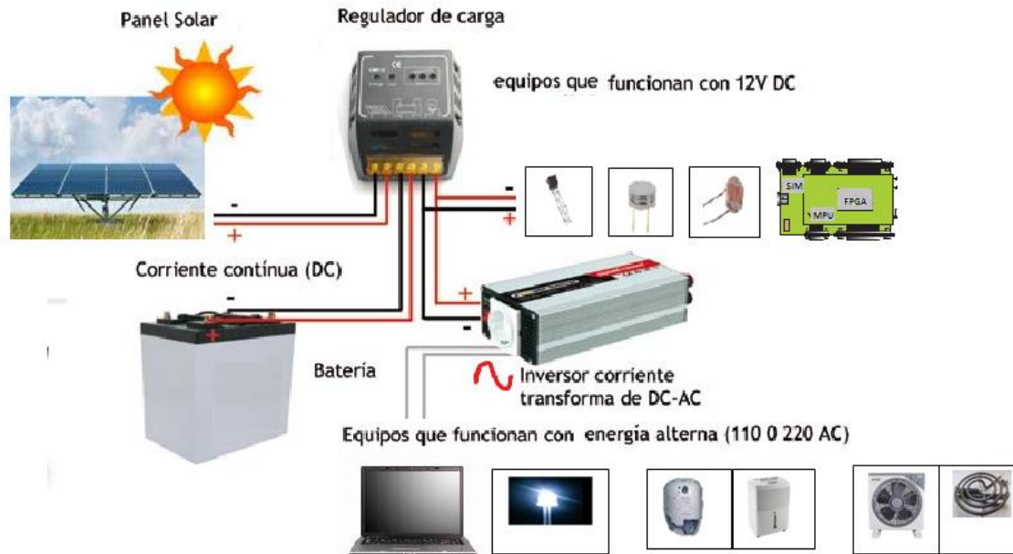
Figura 3.1.2.1 conexiones entre los elementos involucrados para el correcto funcionamiento del sistema basado en energía solar
