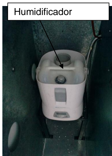
Figura 3.2.3.1 Humidificador en el interior del fitotrón.
