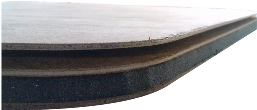
*Composición techo y suelo (Espuma de alta densidad + cama de aire)*
