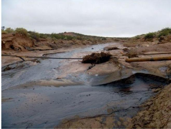
**Ilustración 9. Suelo contaminado por rípios de pozo petrolero.**
