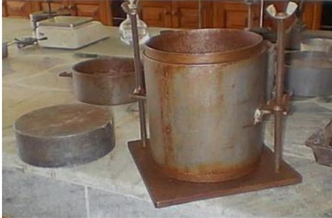
**Ilustración 18. Molde para realizar la prueba de C.B.R.**
