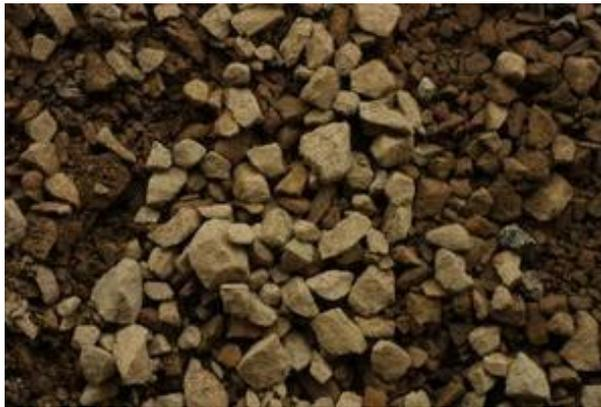
**Ilustración 7. Roca molida por taladro en pozo petrolero, llamados recortes de perforación o ripios.**
