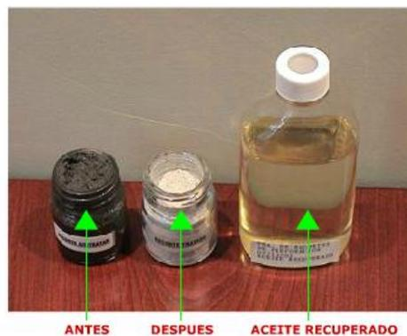
**Ilustración 3. Recortes de Perforación antes y después de la desorción química.**
