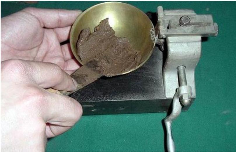
Ilustración 19. Máquina de Casagrande utilizada para la determinación del límite líquido.
