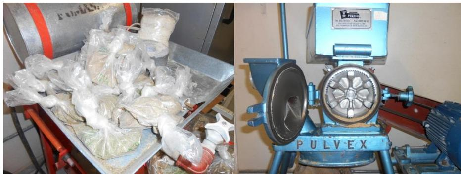
**Figura 16.** Molienda de muestras en molino PULVEX con criba de 1 mm.
