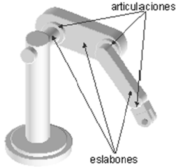
Figura 1. Elementos estructurales de un robot industrial.
