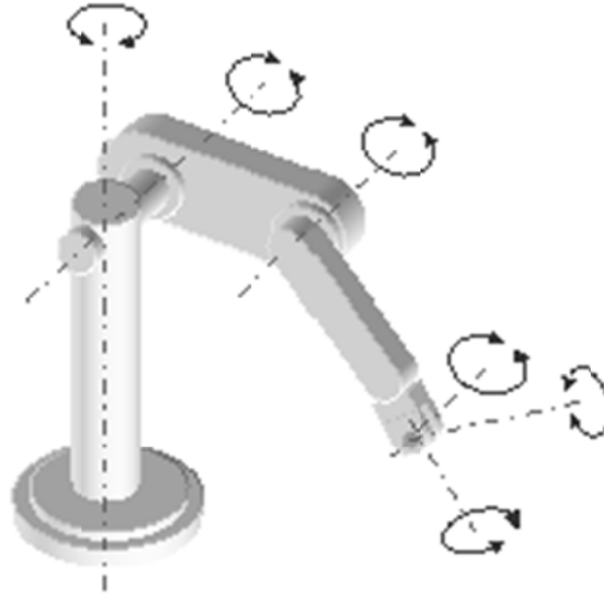
Figura 5. Distintos grados de libertad de un brazo de robot.
