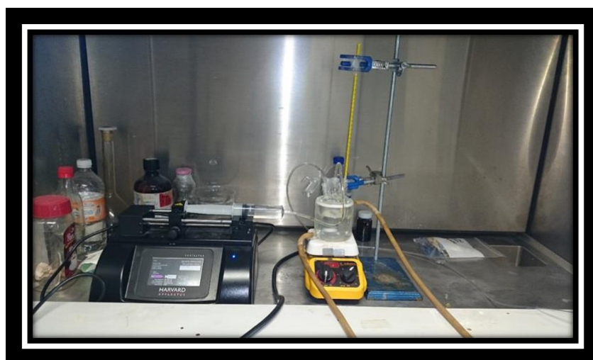
Figura VI-II. Imagen del montaje experimental para la síntesis del líquido iónico formiato de 2-hidroxietilamonio.
