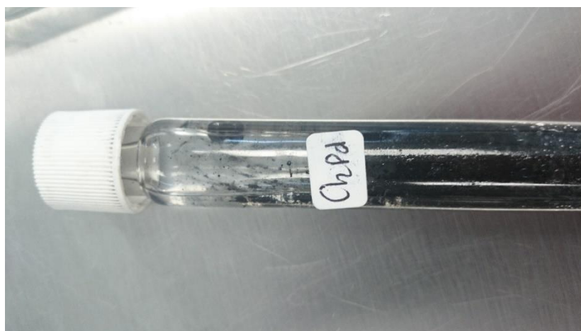
Figura VI-III. Muestra que contiene Pd después de reaccionar con el líquido Iónico formiato de 2-hidroxietilamonio
