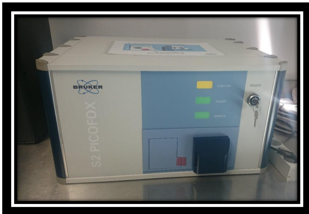
Figura XII-IV. Equipo S2 PICOFOX Bruker© para la caracterización por fluorescencia de rayos X.
