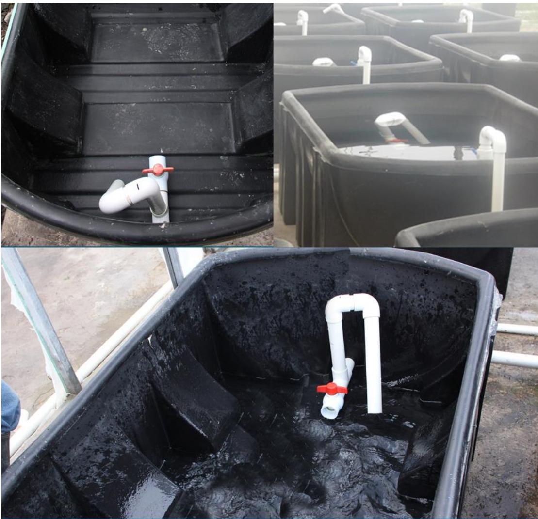
Figura 6. Adaptación de salida de agua de los tanques de cultivo para mantener el volumen máximo de 350 L
