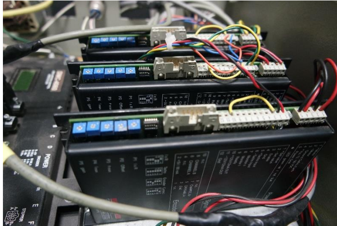
Figura 4-9. Servodrivers modelo Maxon Motor ADS para ejes "x" y "y".
