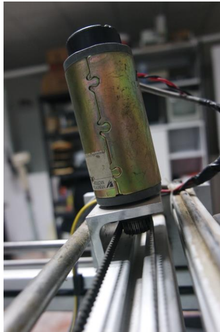
Figura 4-6. Motor DC para eje x de mesa de coordenadas.
