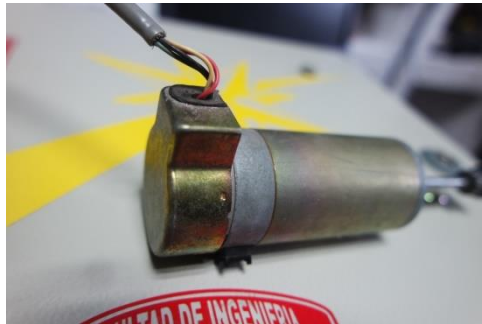
Figura 3-3. Encoder de motor de DC, resolución de 500 CPR a 5V y 200mA.
