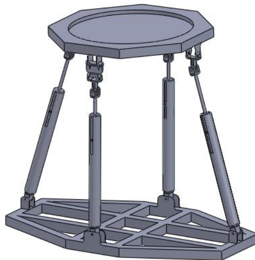
Figuras 5. Esquema de la plataforma paralela sintetizada para llevar a cabo los movimientos de un caballo, la cual está constituida por cuatro patas.
