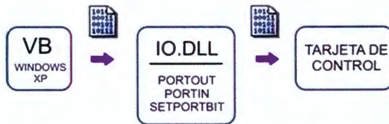
Figura 4.6 Diagrama a bloques de utilización de IO.DLL
