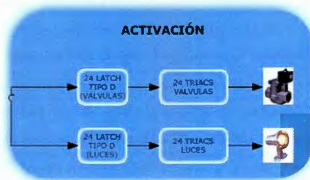
Figura 4.7 Metodología de activación de válvulas y luces
