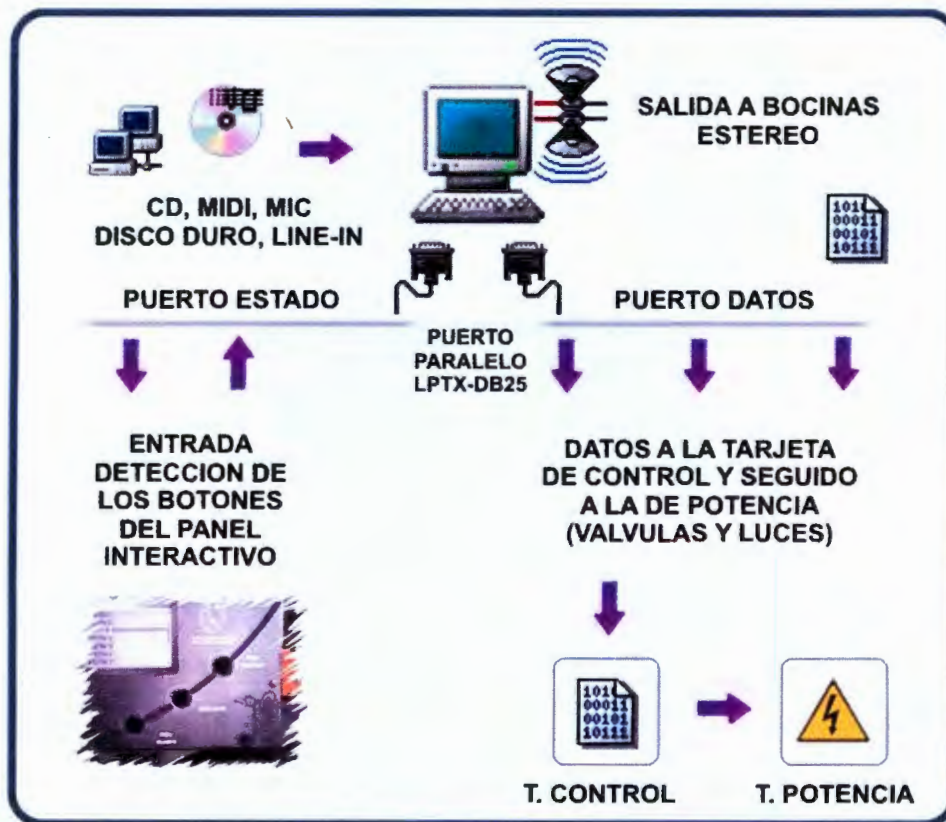
Figura 3.1 Diagrama a bloques del desarrollo del hardware
