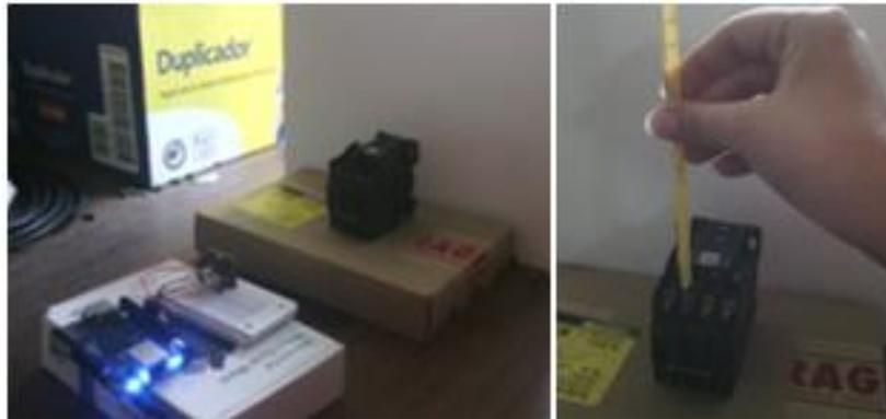
**Figura 3-7 Montaje de calibración a) cámara infrarroja b) termómetro de mercurio.**
