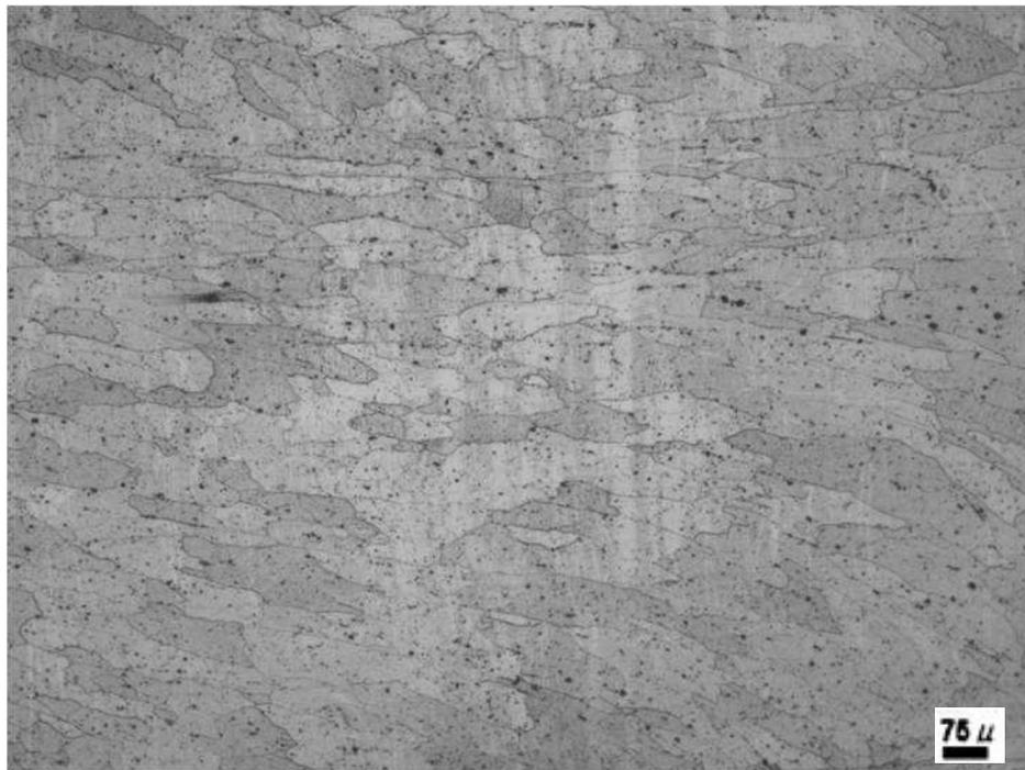
Figura 10. Muestra 5 envejecida por 120 minutos correspondiente al núcleo de soldadura, 100X.
