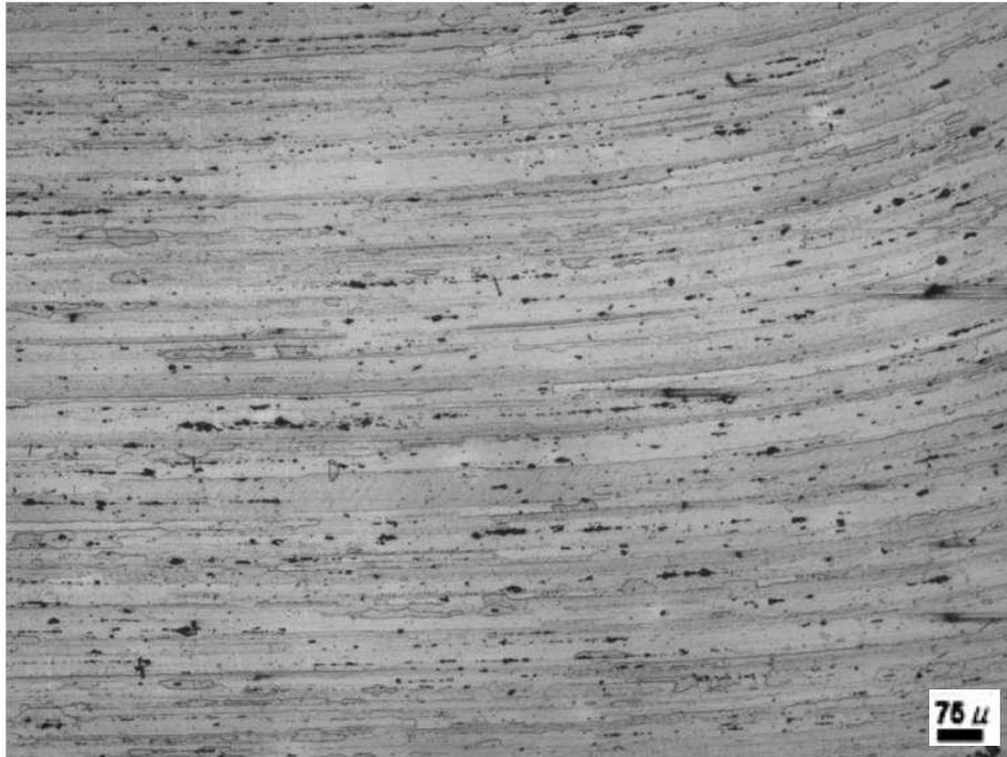
Figura 7. Muestra 4 envejecida por 90 minutos correspondiente a la zona afectada por el calor, 100X.
