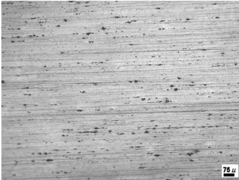
Figura 16. Muestra 6 envejecida por 150 minutos correspondiente a la zona afectada por el calor, 100X.
