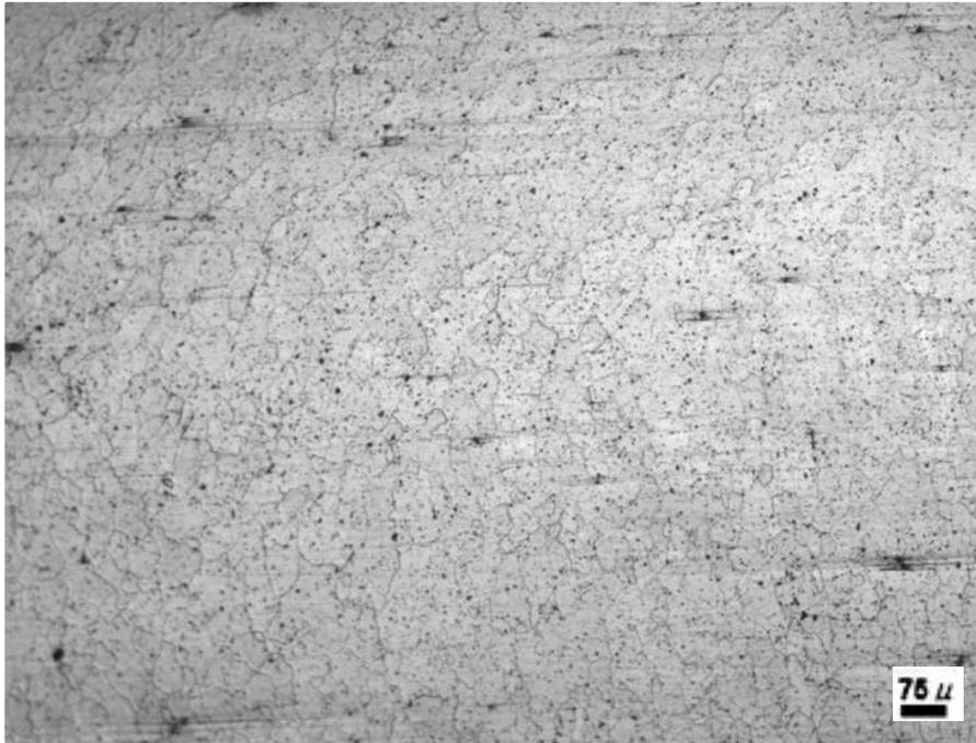
Figura 15. Muestra 6 envejecida por 150 minutos correspondiente al núcleo de soldadura, 100X.
