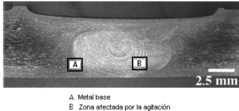
Figura 4. Capa de una soldadura sobre una aleación de aluminio de 6.35 mm de espesor (Ponte y col., 2006).
