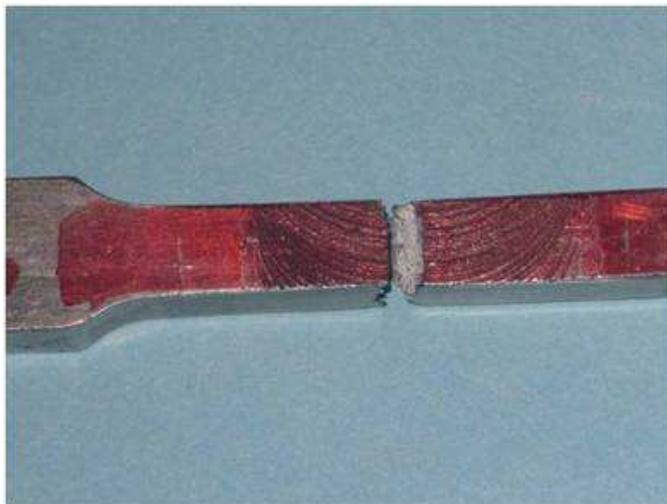
Figura 35. Fractura típica del material envejecido.
