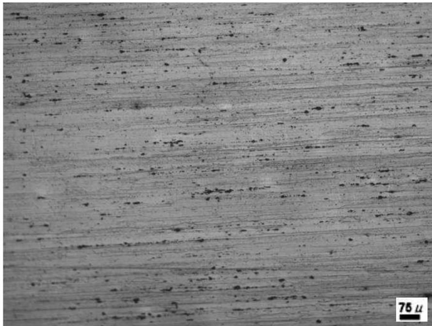
Figura 14. Muestra 6 envejecida por 150 minutos correspondiente al metal base, 100X.
