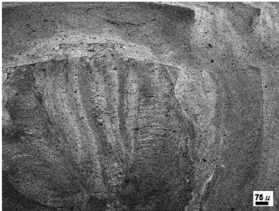
Figura 16. Muestra 1 correspondiente al núcleo de soldadura, 50X.
