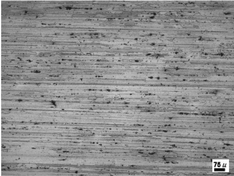
Figura 3. Muestra 3 envejecida por 60 minutos correspondiente a la zona afectada por el calor, 100X.
