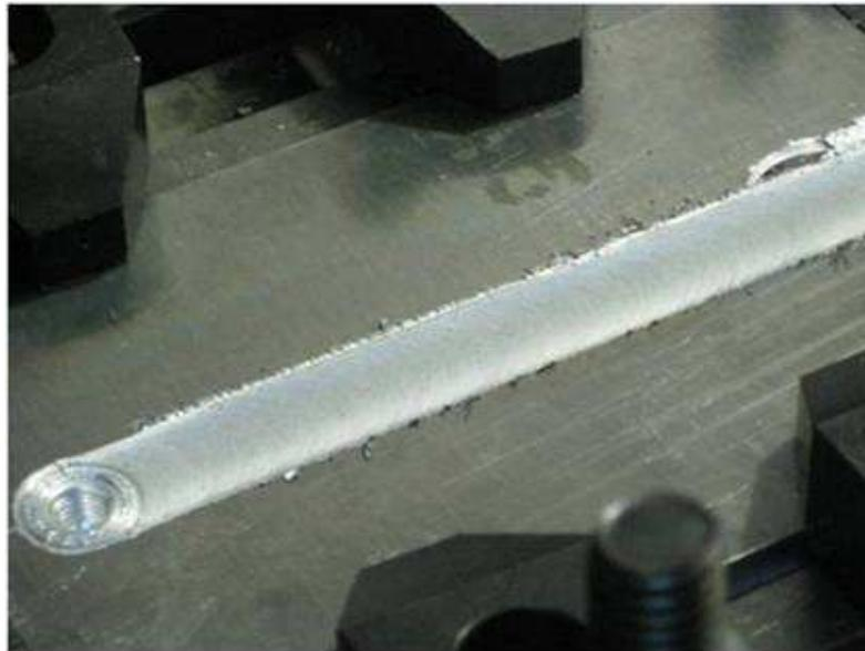
Figura 13. Junta soldada por el método de Fricción-Agitación.
