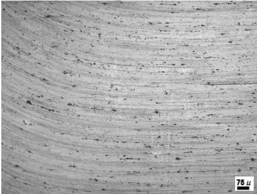
Figura 17. Muestra 6 envejecida por 150 minutos correspondiente a la zona afectada termo-mecánicamente, 100X.
