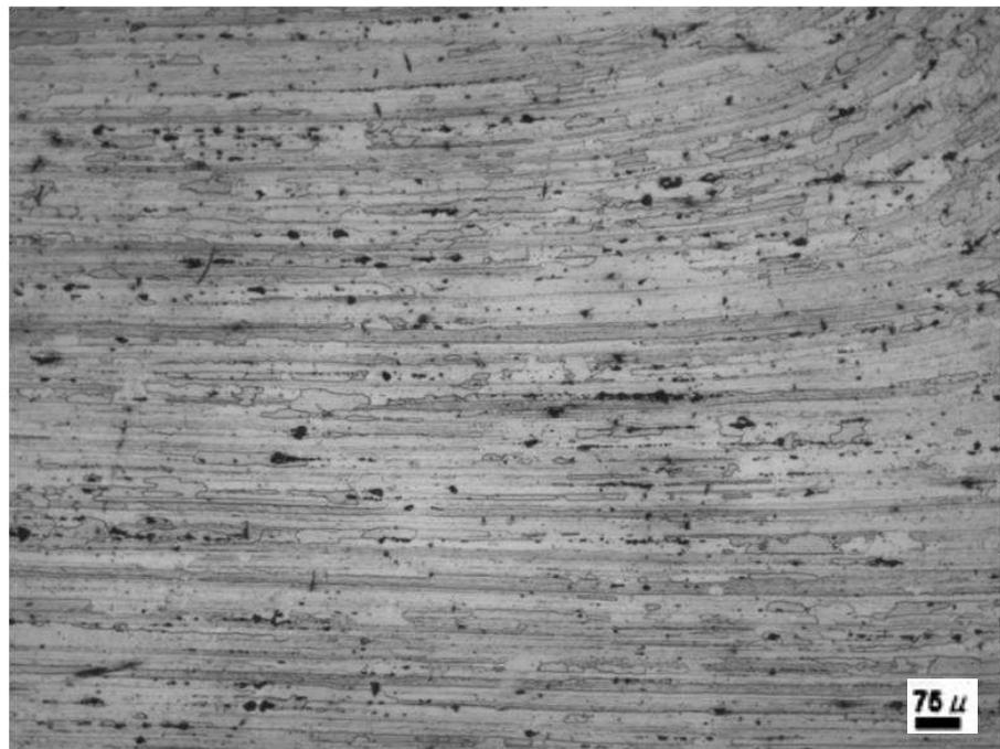
Figura 4. Muestra 3 envejecida por 60 minutos correspondiente a la zona afectada termo-mecánicamente, 100X.
