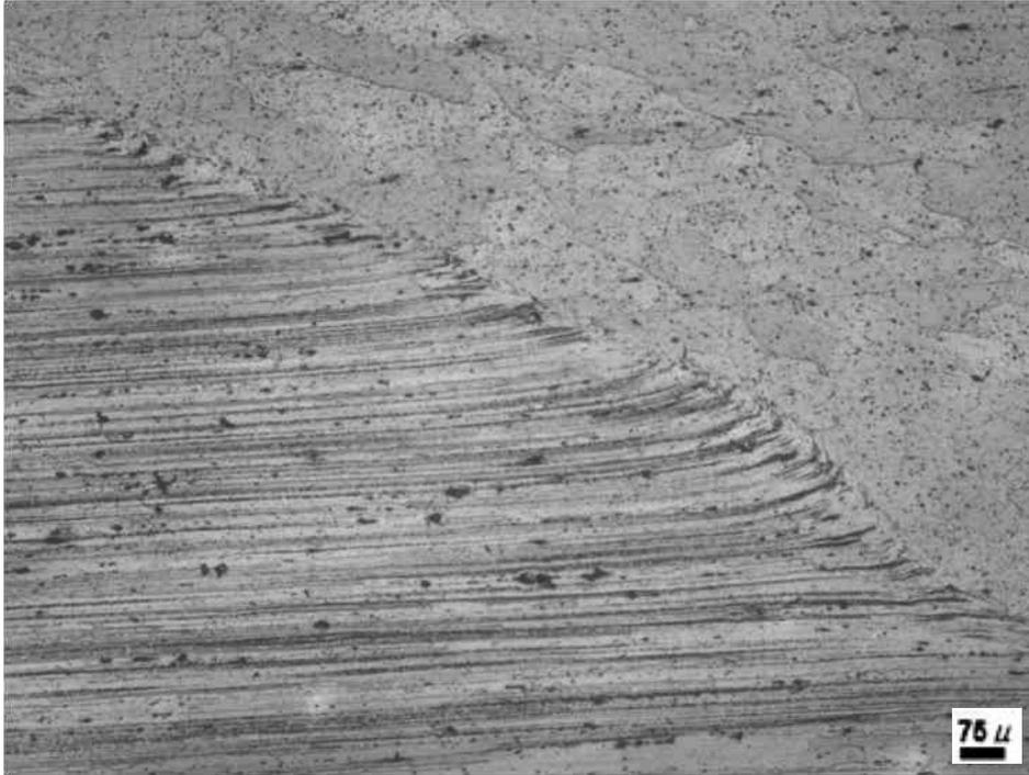
Figura 21. Muestra 7 envejecida por 180 minutos correspondiente a la zona afectada termo-mecánicamente, 100X.
