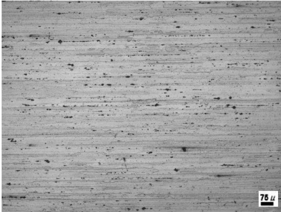
Figura 5. Muestra 4 envejecida por 90 minutos correspondiente al metal base, 100X.
