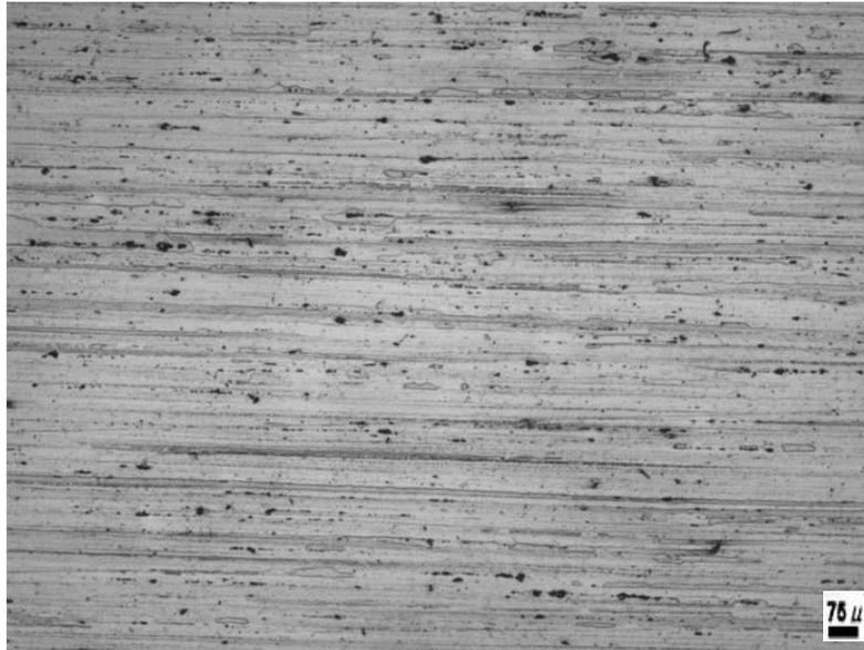
Figura 1. Muestra 3 envejecida por 60 minutos correspondiente al metal base, 100X.
