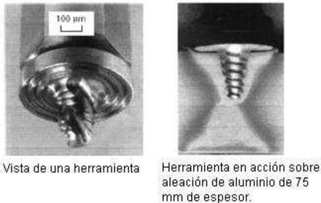
Figura 6. Herramientas de soldadura (Cazes, 1996).
