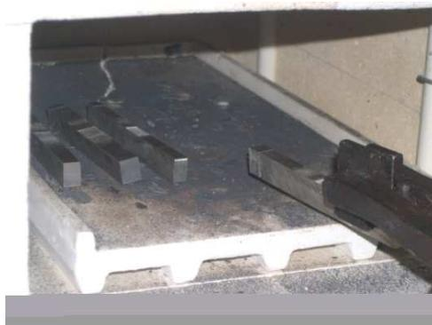
Figura 37. Horno utilizado para realizar los tratamientos térmicos de solubilización y envejecimiento artificial.
