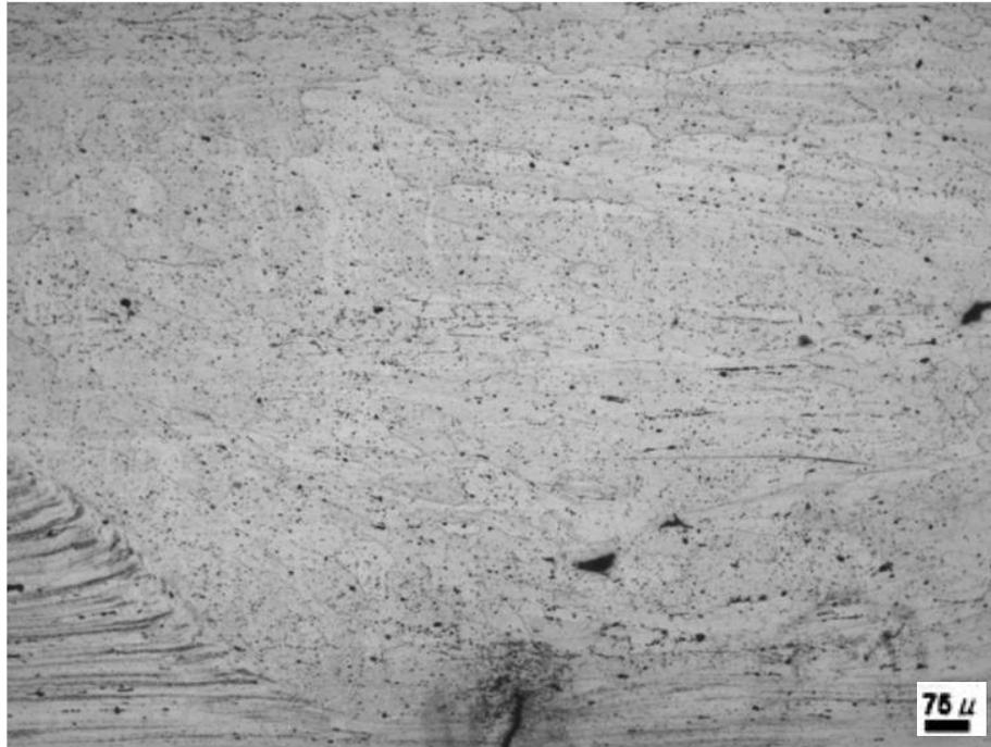
Figura 19. Muestra 7 envejecida por 180 minutos correspondiente al núcleo de soldadura, 100X.
