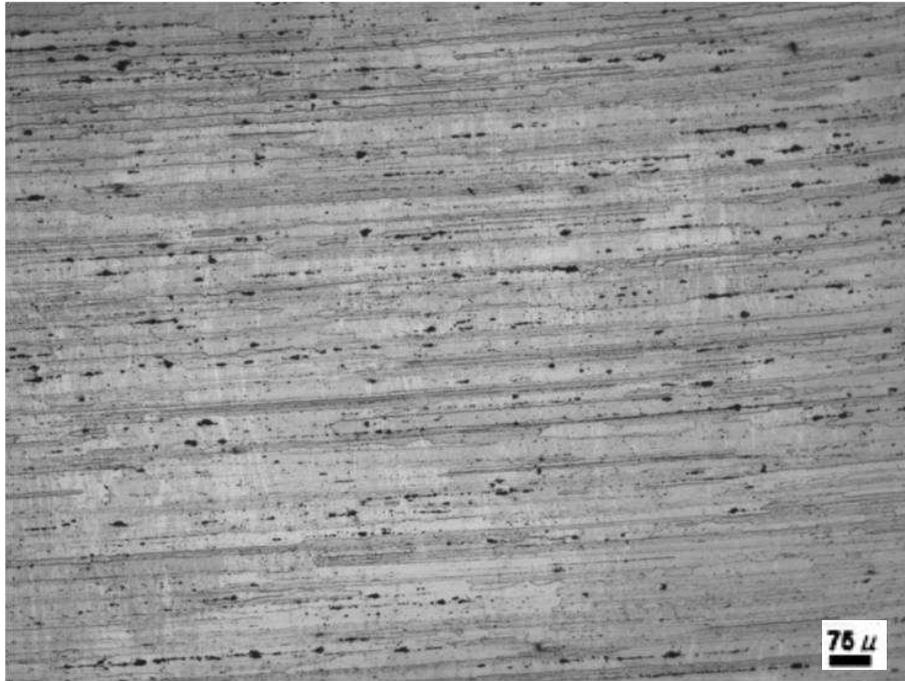
Figura 11. Muestra 5 envejecida por 120 minutos correspondiente a la zona afectada por el calor, 100X.
