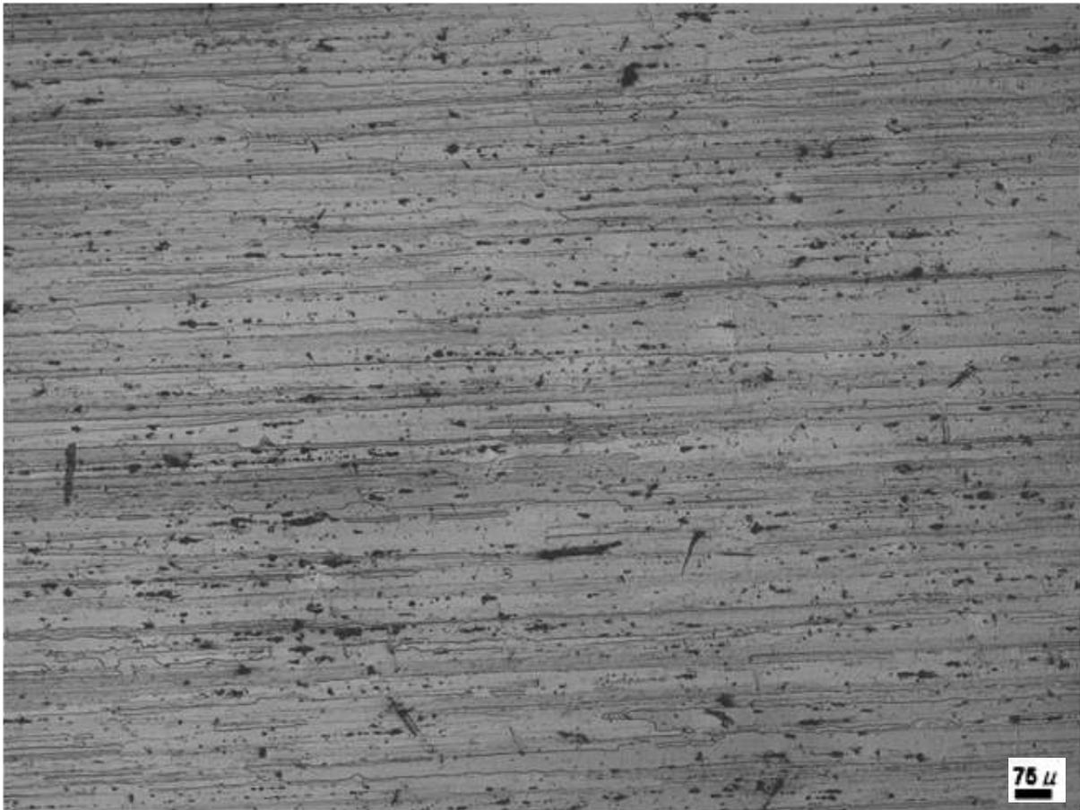
Figura 14. Muestra 1 correspondiente al metal base, 100X.
