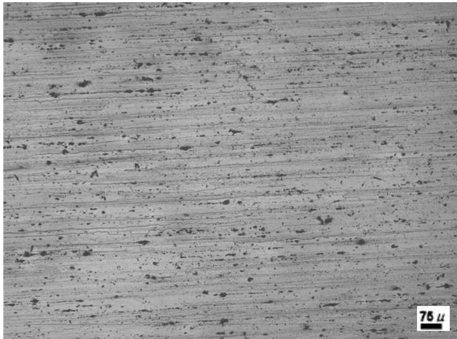
Figura 18. Muestra 1 correspondiente a la zona afectada térmicamente, 100X.
