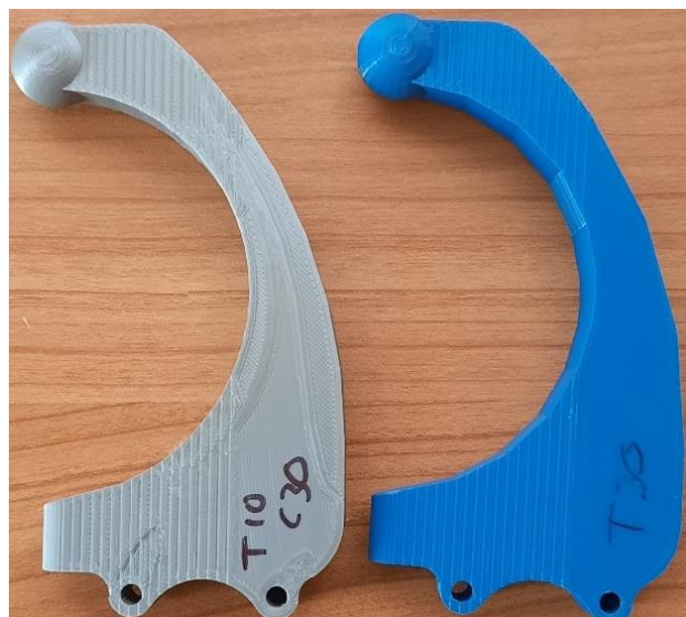
Figura 4.8 Diferencia en la apariencia física entre modelos de impresión convencional y rellenos combinados impresos con la herramienta de Normal Model en CURA.
