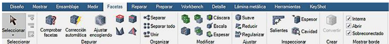
Figura 3.14 Herramientas de edición de modelos en formato de malla, ubicados en la pestaña de Facetas.
