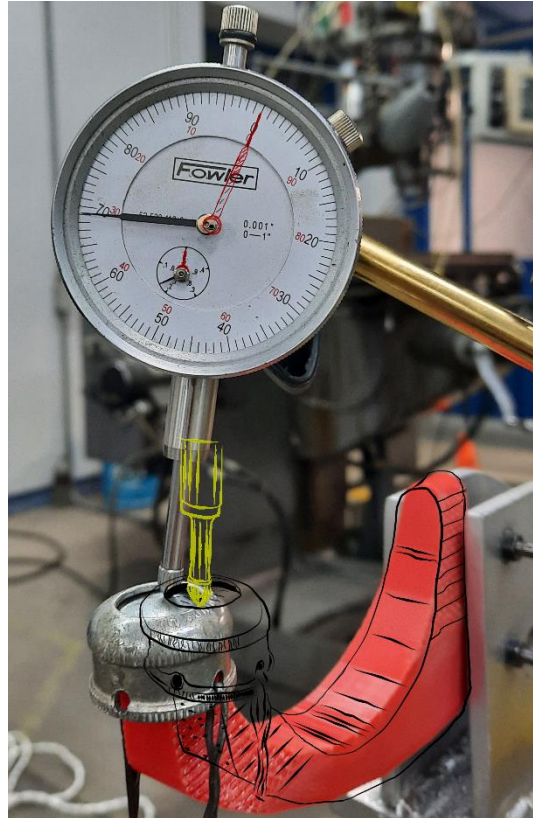
Figura 4.12 Comparación entre la lectura del indicador de carátula de los estados de reposo y flexión de la pinza C_30
