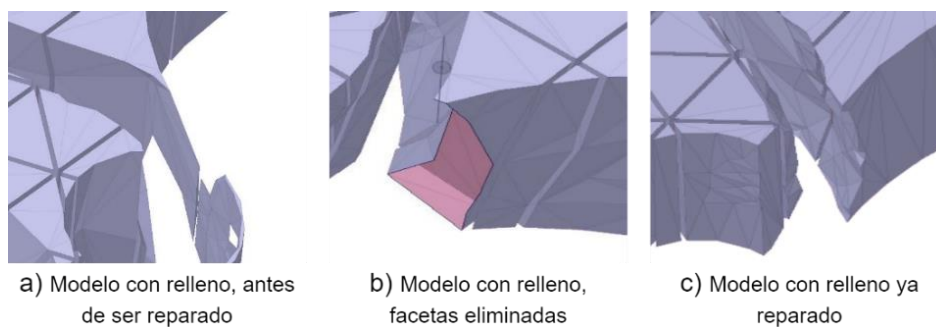
Figura 3.15 Corrección a facetas de modelo STL: Triangulo con relleno combinado 30%_10%.
