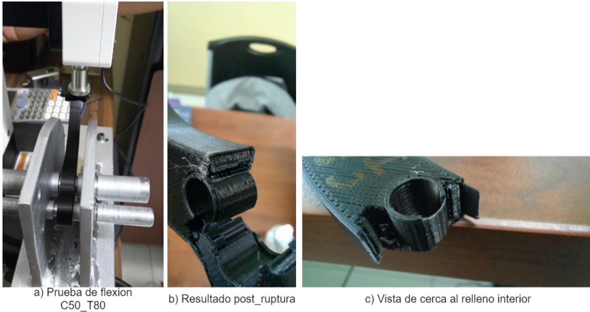
Figura F 7 Evidencia de un pedal instalado durante la prueba y su apariencia resultante..
