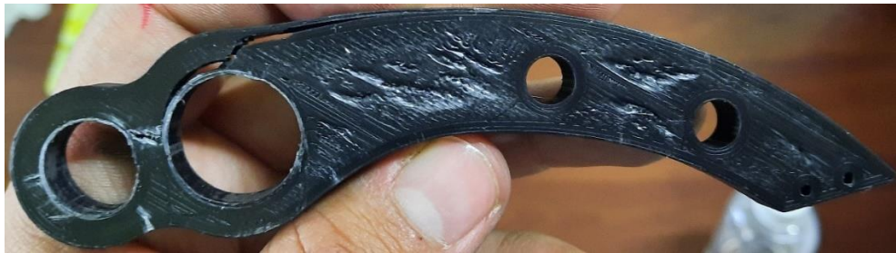
Figura 4.26 Vista posterior de la falla del pedal Cuadrado 80.
