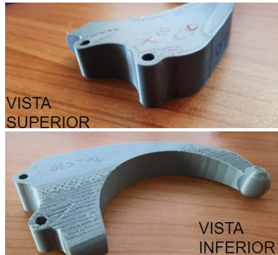
Figura 4.7 Apariencia exterior post impresión modelo de relleno combinado T10_C30.
