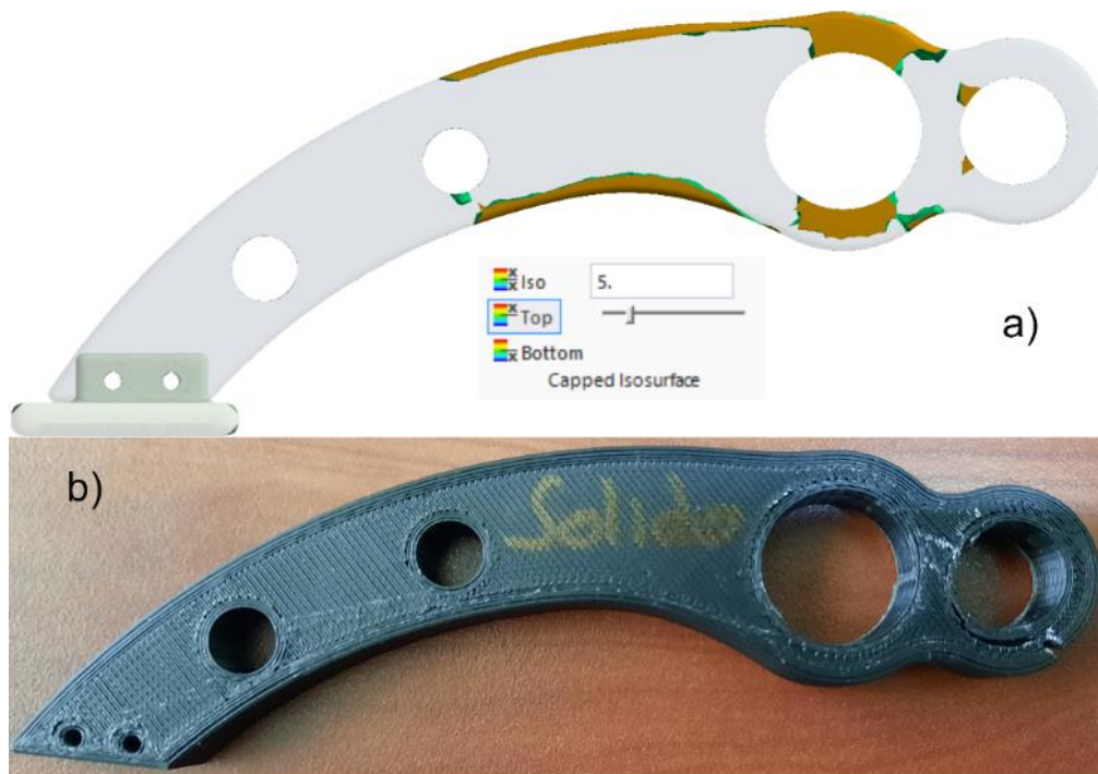
Figura 4.28 Resultados de pruebas de simulaciones y reales para el pedal sólido
