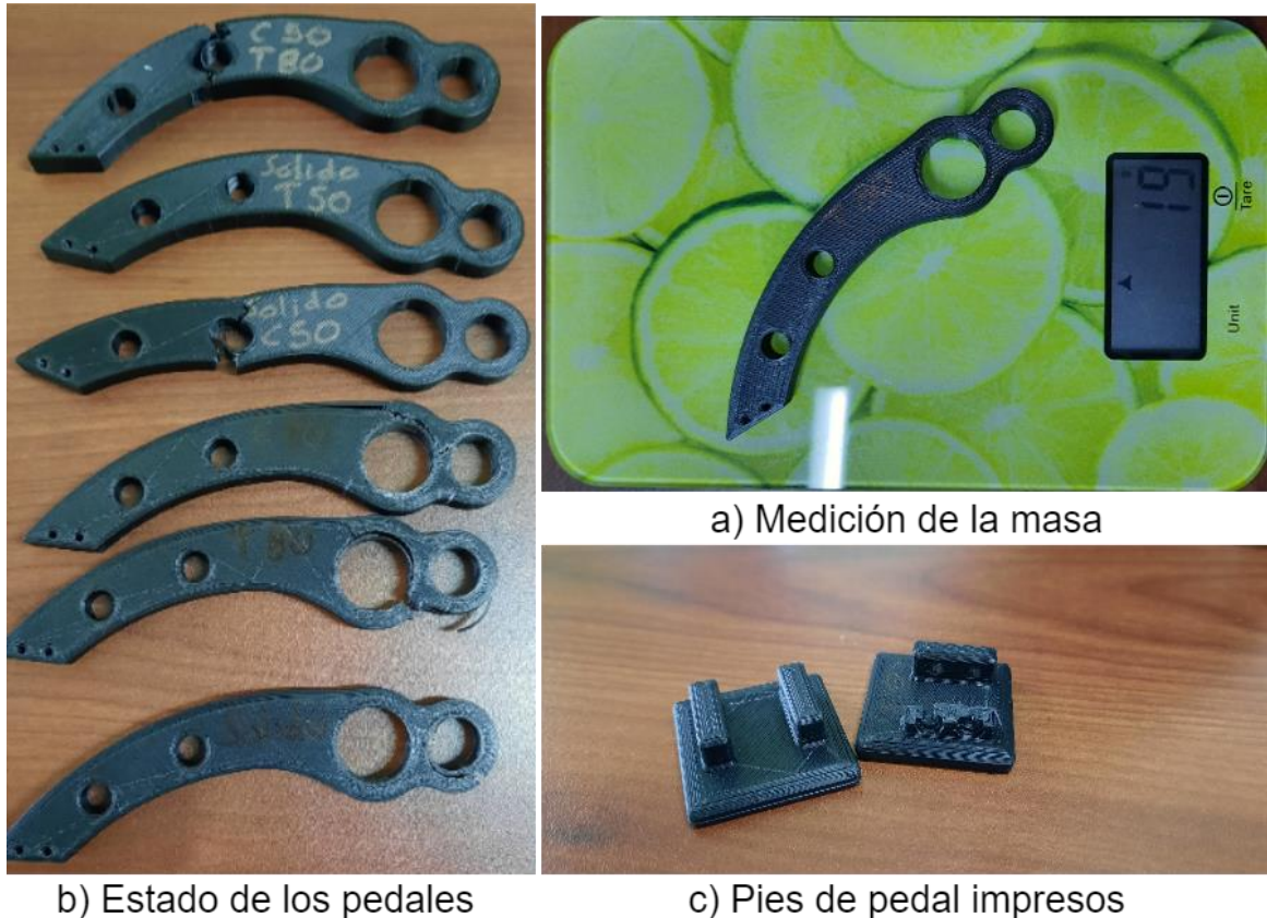
Figura F 6 Medición de la masa de los pedales post- impresión y apariencia resultante post-pruebas destructivas.
