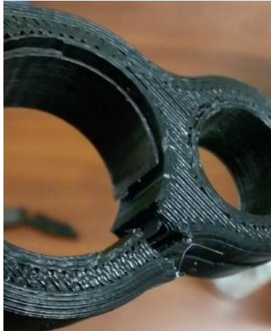
Figura 4.27 Vista más a detalle de la separación entre perímetros laterales.
