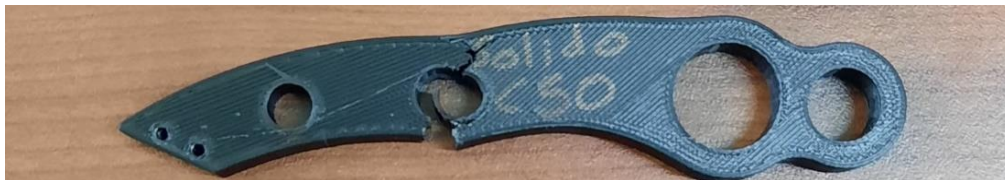
Figura 4.24 Resultado final del pedal con rellenos combinados Sólido_Cuadrado final después de las pruebas
