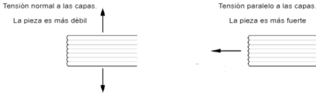
Figura 2.16 Diferente impacto de cargas en tensión sobre piezas impresas (Erasmus+ 3D printing VET centres, 2017).
