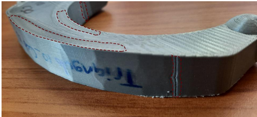
Figura 4.9 Des continuidad en el perímetro exterior de las pinzas con rellenos combinados
