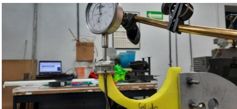
Figura 4.11 Pinza sólida instalada en placa de pruebas con el indicador de carátula marcando “0”
