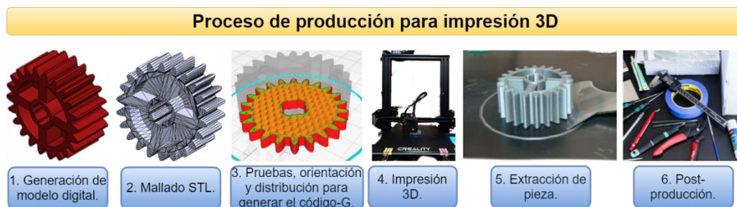
Figura 2.1 Proceso de producción para la impresión 3D por filamento fundido.
