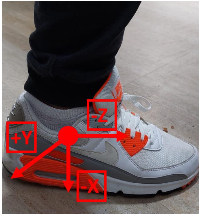
Figura 4.8 Acomodo de ejes X-Y-Z con respecto al posicionamiento del sensor al tobillo.
