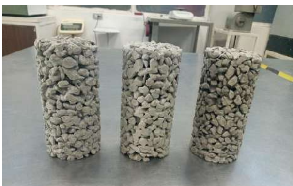
Figura 62 Cilindros de concreto (A/C= 0.3, 0.4 y 0.5 de izquierda a derecha)
