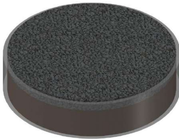
Figura 22 Estructura pétreá porosa sobre el suelo, dentro del anillo de consolidación
