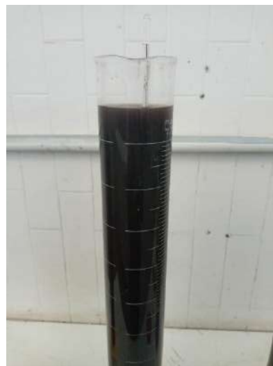
Figura 81 Medición con hidrómetro
