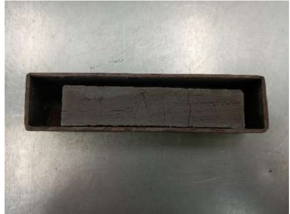
Figura 36 Molde de contracción lineal con suelo seco
