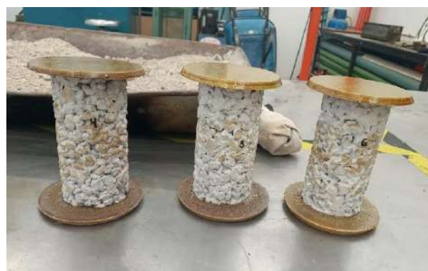
Figura 63 Cilindros de concreto cabeceados con azufre
