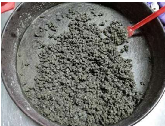
Figura 19 Mezcla de concreto permeable
