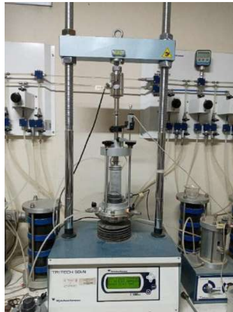
Figura 52 Prueba de resistencia a la compresión en cámara triaxial
