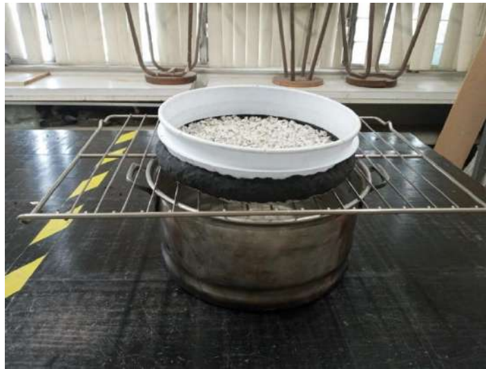
Figura 65 Placa de concreto con anillo de infiltración en su superficie
