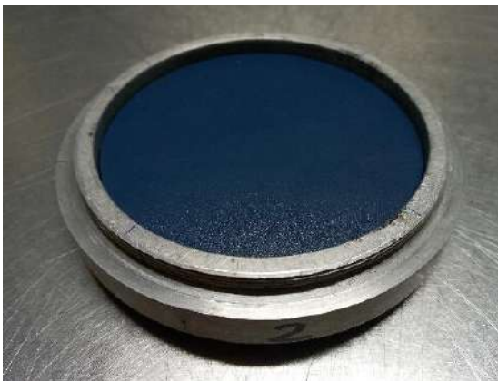
Figura 18 Molde para colado de estructura pétreo 3
