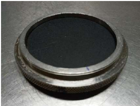
Figura 16 Molde para colado de estructura pétreo 1
